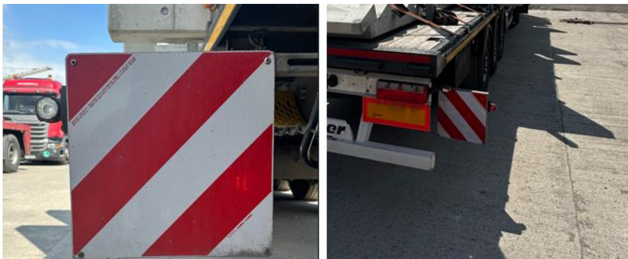
Obrázek č. 33 Označení přesahujícího nákladu Zdroj (autor)
