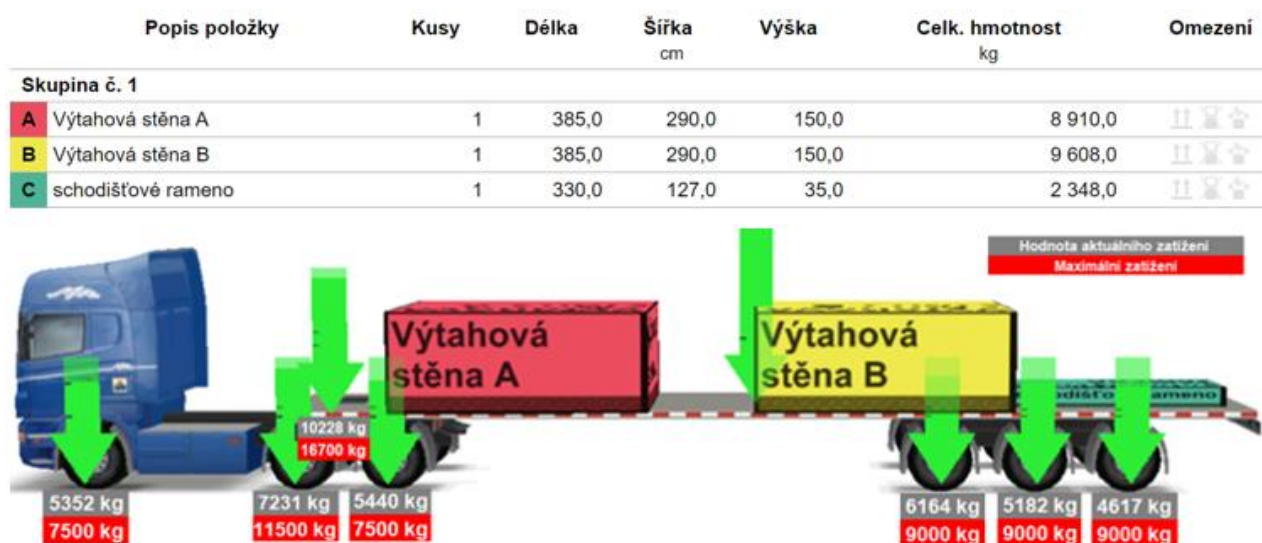
Obrázek č. 26 Optimalizované rozložení nákladu na ložné ploše
