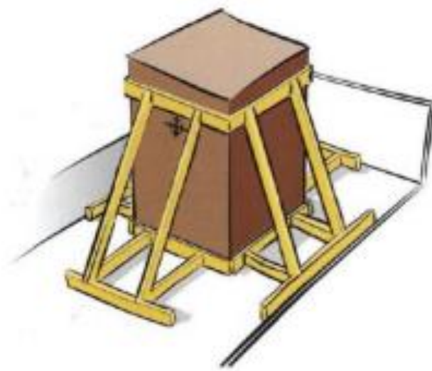
Obrázek č. 4 Zapření nákladu podpěrami
