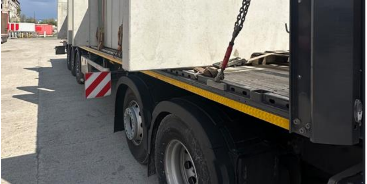
Obrázek č. 29 Znárodnění přesahu nákladu
