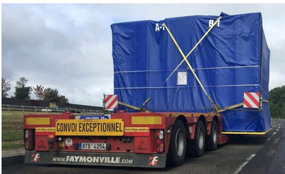
Obrázek č. 21 Překřížené uvázání nákladu
