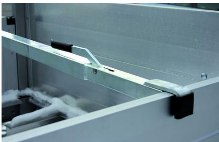
Obrázek č. 13 Zajištění mezibočnicové zábrany
