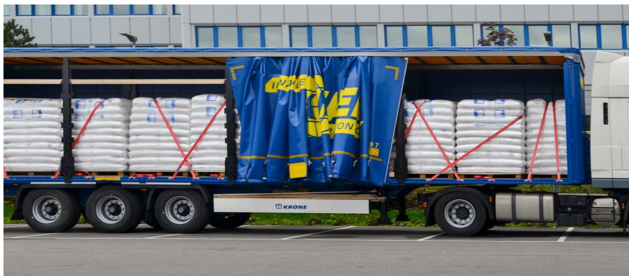
Obrázek č. 14 Správné blokování nákladu
