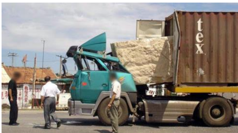
Obrázek č. 16 Špatné uložení nákladu
