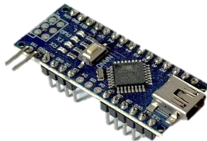
Obrázek 8: Arduino Nano R3, ATmega328 [14]
