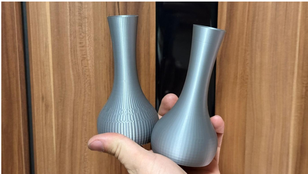
Obrázek 26: Srovnání výtisku od robota a Bambulab 3D tiskárny
