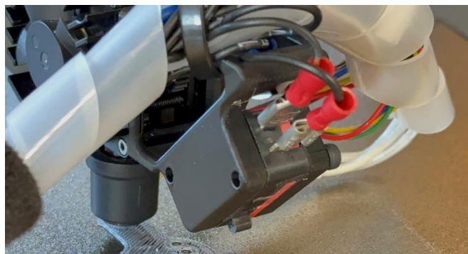
Obrázek 14: Uchycení kalibračního tlačítka a kabeláže
