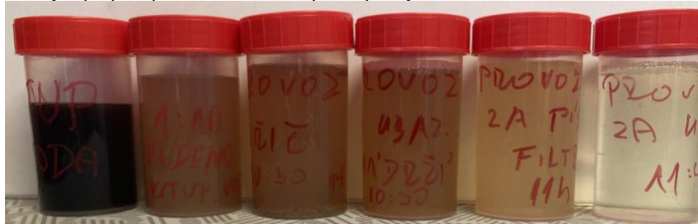
d) Vzorky OV WWW3 z poloprovodní zkoušky. Zleva: původní OV, po úpravě pH pro čiření, po čiření, po usazení, po pískové filtraci, po ultrafiltraci-voda připravená pro vstup do fotoreaktoru
