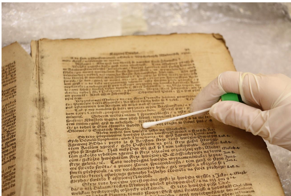
Obr. 58 Štěr pro analýzu mikrobiologického napadení
