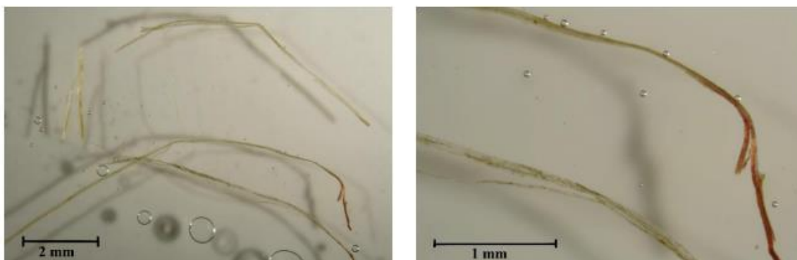
Snímek vláken vzorku AN3/11503 v Herzbergově činidle. Fotografováno na optickém mikroskopu Nikon ECLIPSE LV100 při zvětšení na mikroskopu 50x, 100x, 200x v bílém procházejícím světle. V roztoku fluoroglucínu fotografováno na stereomikroskopu SMZ 800, bílé dopadající světlo, zvětšení na mikroskopu 10, 30x.
