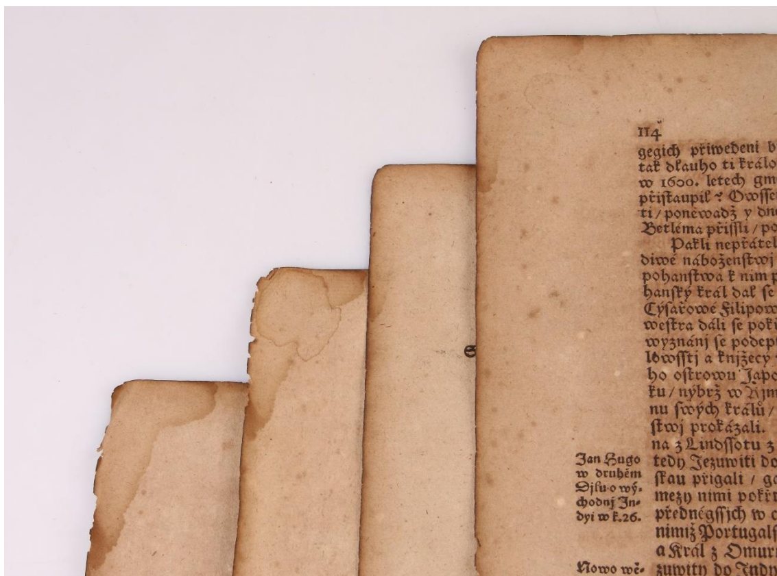
Obr. 70 Zkoušky mokrého čištění – před (zleva: porovnávací dvojlist, koupel jen v H 2 O, koupel v H 2 O s tenzidem, koupel v H 2 O a obohacené vodě)
