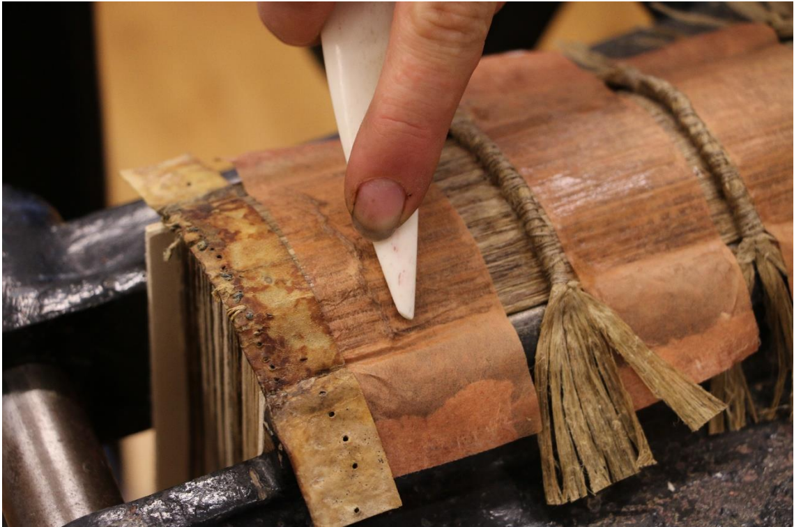
Obr. 106 Lepení kapitálků a mezivazních přelepů na hřbet
