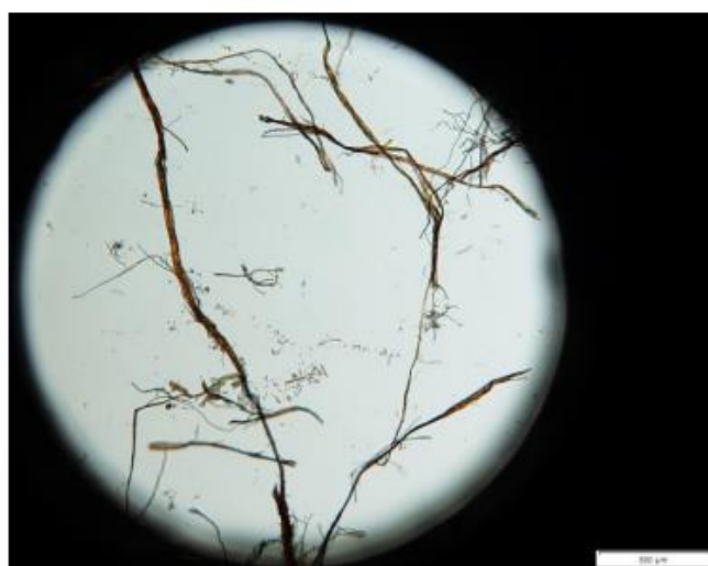
Obr. 4 Vzorek v měřící cele FP82, před měřením teploty smrštění
