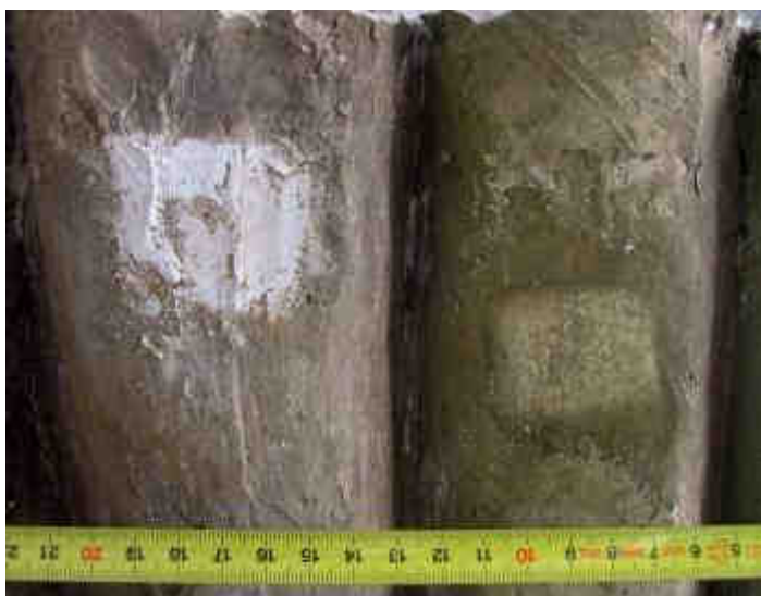
Zkoušky čištění, vlevo vodní pára, vpravo líh
