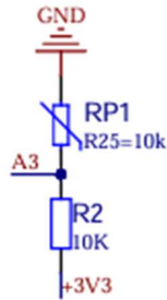
Obrázek 26 Zapojení termistoru [Autorská práce (Altium Designer)]
