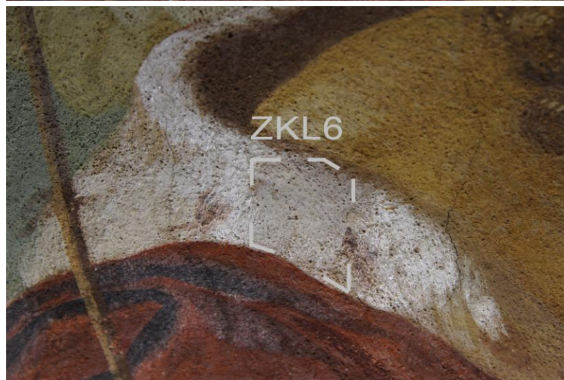
Obr. 68: Zkoušky redukce lesků fixáže. ZKL6 – zábal z Abrocelu a teplé destilované vody.
