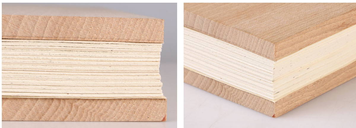
Obr. 91 Pohled na roh knihy, knižní desky netvoří kanty pro knižní blok
