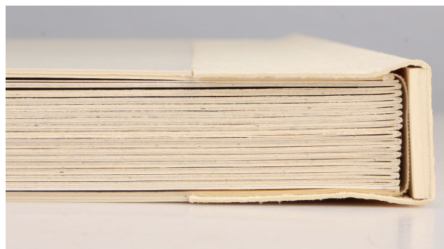
Obr. 99 Pokrytí hřbetu knižního bloku a vyrovnání výškového rozdílu mezi pokryvem a vnitřními deskami
