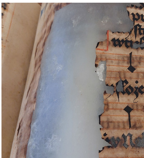
Obr. 32 Změna struktury papírové podložky a viditelné stopy po slepení fólie
