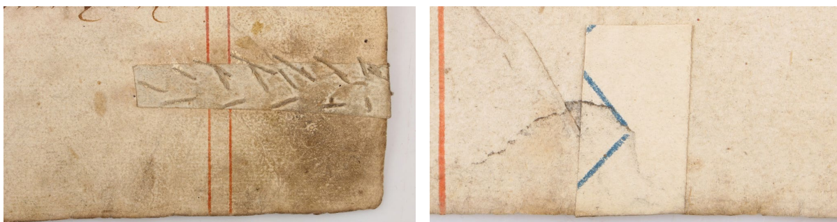
Obr. 128 Ukázka vysprávek, vysprávka připevněná prošitím (vlevo) a nalepením (vpravo)
