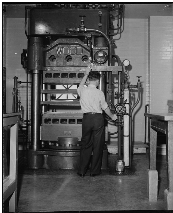
Obr. 20 Tepelná laminace, Národní archiv, Washington, D.C., 1939 (foto: online zdroj)
