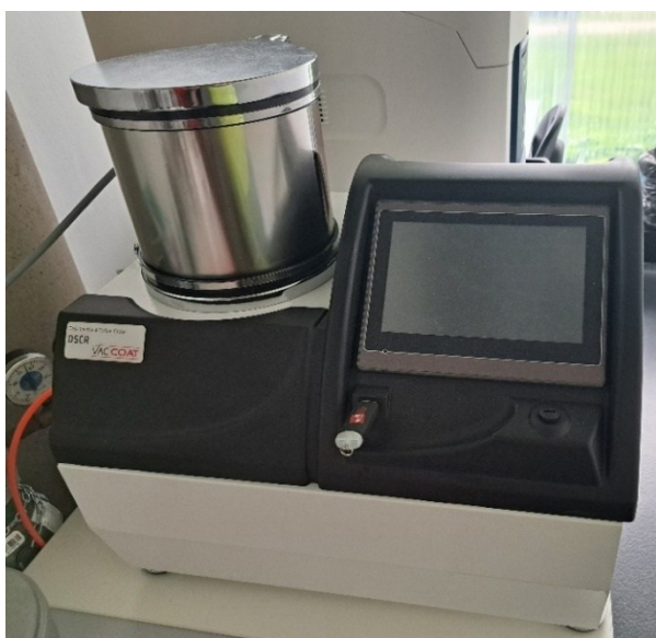
Obrázek 13 Vakuová naprašovačka (vlevo) a SEM (vpravo)
