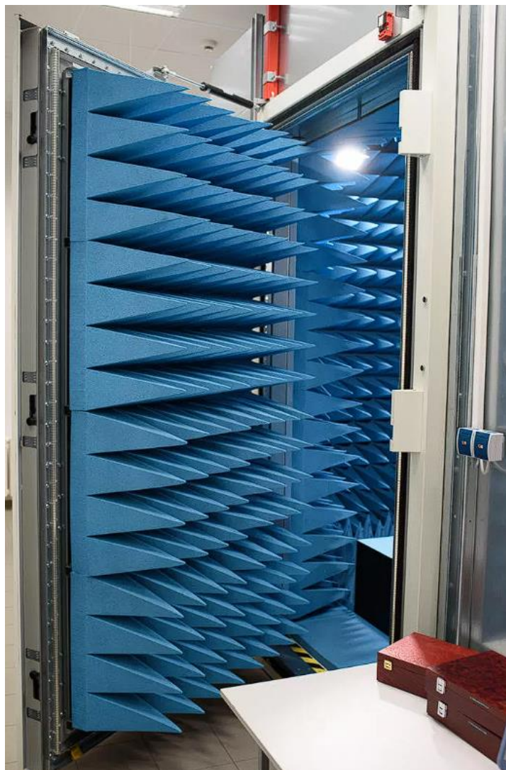
Obrázek 6 Zajištění netěsností dveří komory[9]
