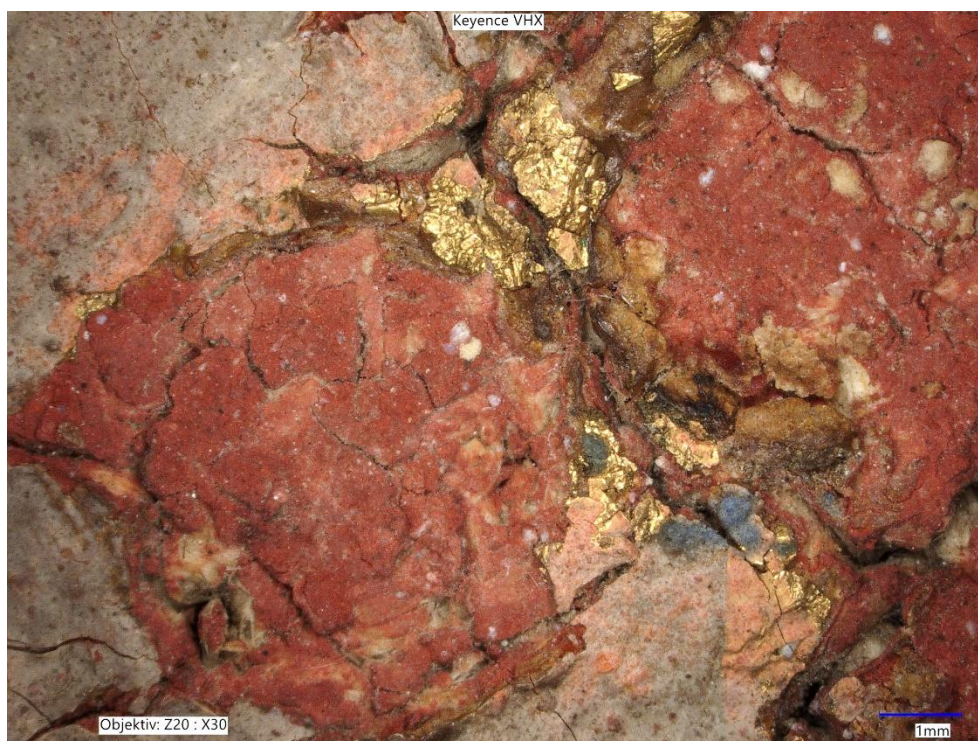
Obr. 30 Stav před restaurováním, Keyence VHX, líc, detail zbytků zlacení
