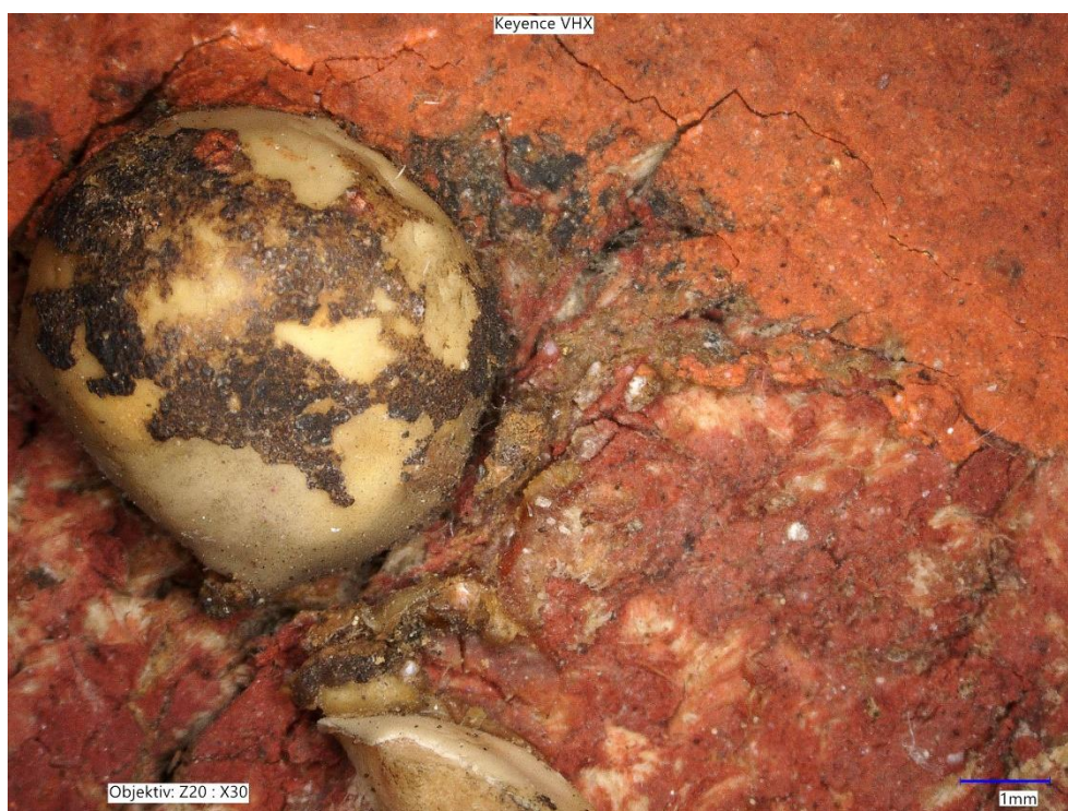
Obr. 29 Stav před restaurováním, Keyence VHX, líc, detail fragmentu aplikací
