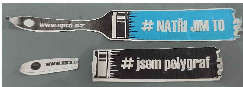
Obrázek 13 Deformace tvaru a přetržení u PE samolepek (teplo)
