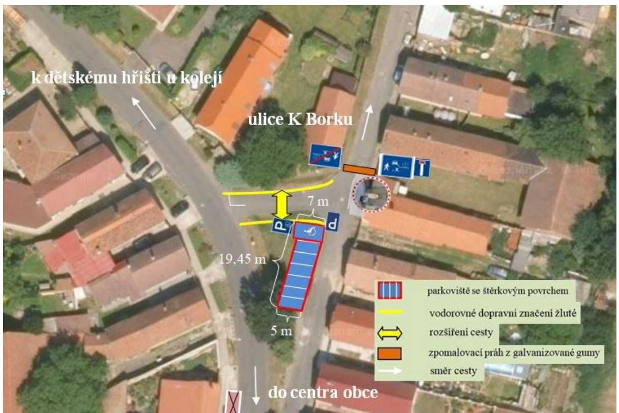
Obrázek 53 Návrh řešení křižovatky směrem "K Borku" (Mapy.cz, 2022, Topznak, b. r., Čermák – Dopravní značení, b. r., Wikipedie, 2024, Výdoz, s. r. o., © 2019–2024b, Povinné ručení, 2024, Zákruta, b. r.b, Safety shop, © 2021–2024, upraveno autorem)
