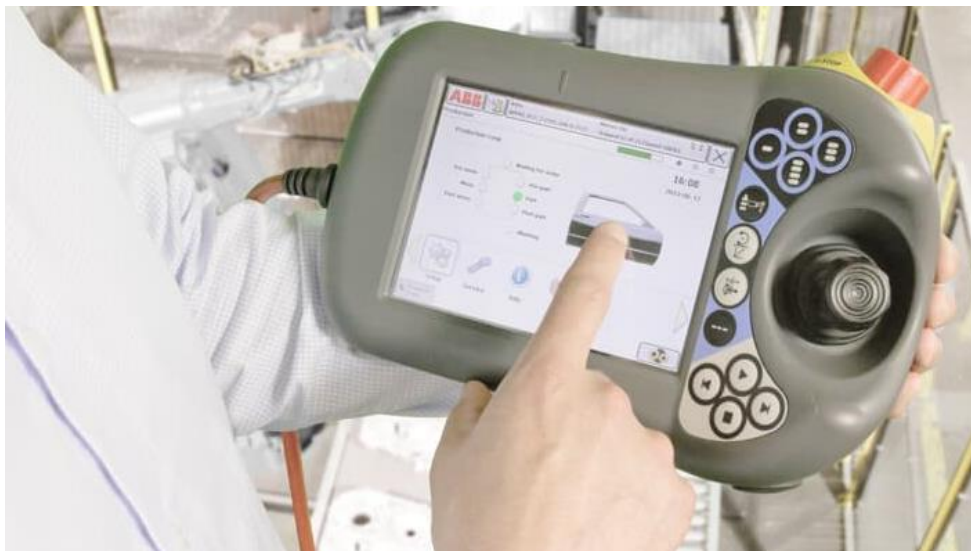
Obrázek 4.15 – Ukázka GUI na FlexPendantu (IRC5 with FlexPendant – Návod k použití, 2018)
