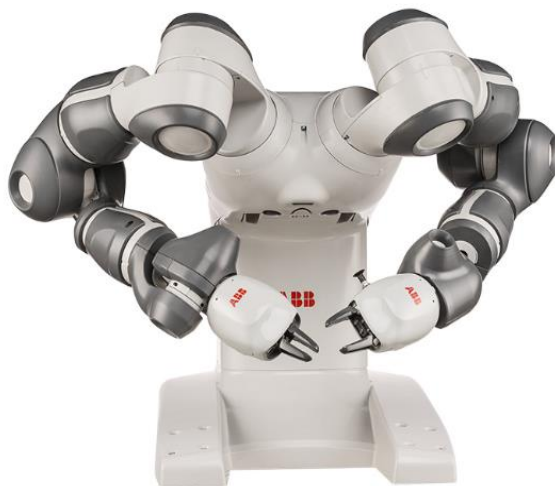
Obrázek 3.1 – Robot ABB YuMi IRB 14000 (IRB 14000 YuMi, 2020)
