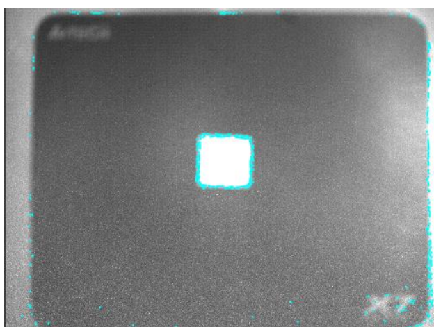
Obrázek 4.3 – Detekované hrany při kalibrační metodě Edge To Edge
