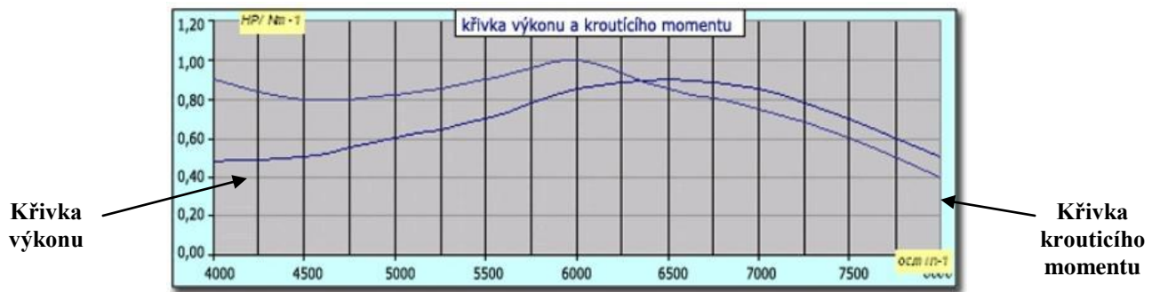
Graf 1 Křivka výkonu a krouticího momentu dvoudobého motoru [ 12 ]
