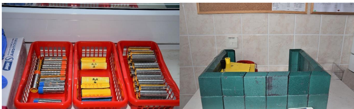
Obrázek 13 Olověné kryty na stříkačky (vlastní zdroj) Obrázek 14 Olověné stínění pracoviště (vlastní zdroj)
