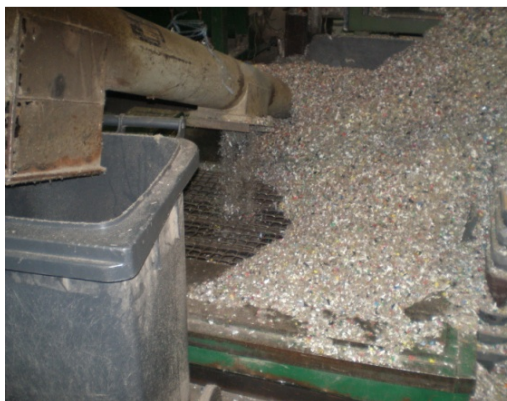
Obrázek 23: Směšovací jímka – míchání aglomerátu s mletinou
