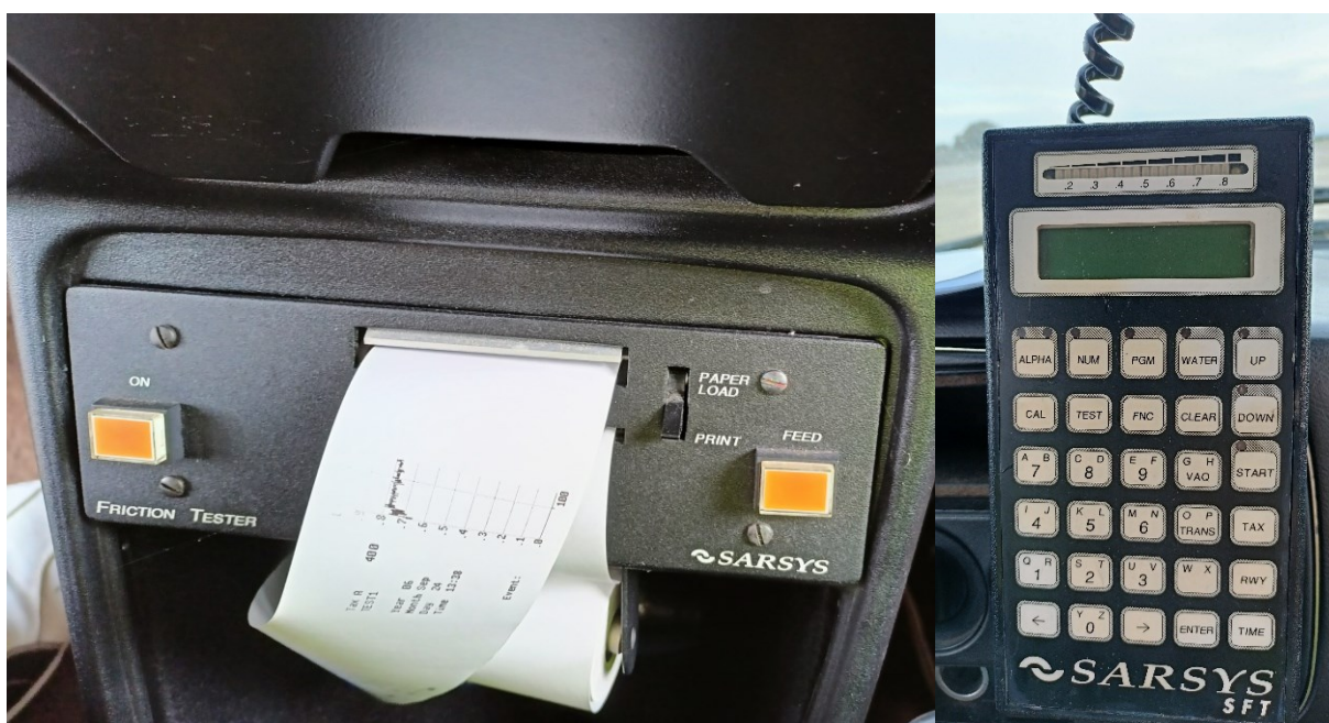
Obr. 36 Tiskárna s fotorpapírem a řídicí panel
