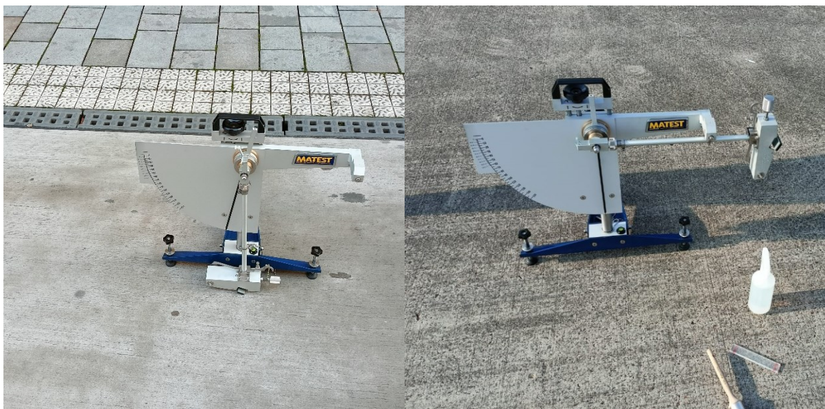
Obr. 32 Vlevo měření na ulici Sladkovského, vpravo měření na LKHK
