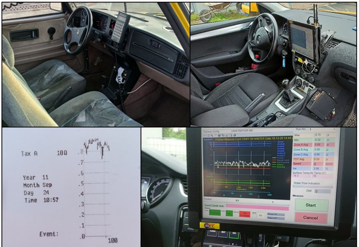
Obr. 39 Digitalizace systému, vlevo SAAB SFT, vpravo ŠKODA ASFT
