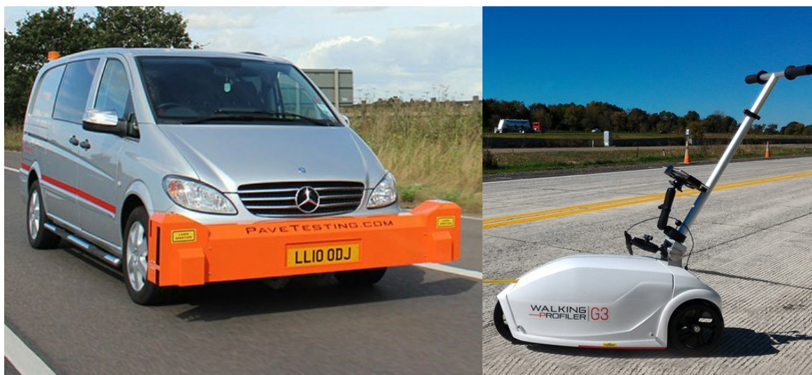
Obr. 17 Vlevo Pojízdný profilometr s vysokou rychlostí měření [52], vlevo profilometr s nízkou rychlostí měření [53]
