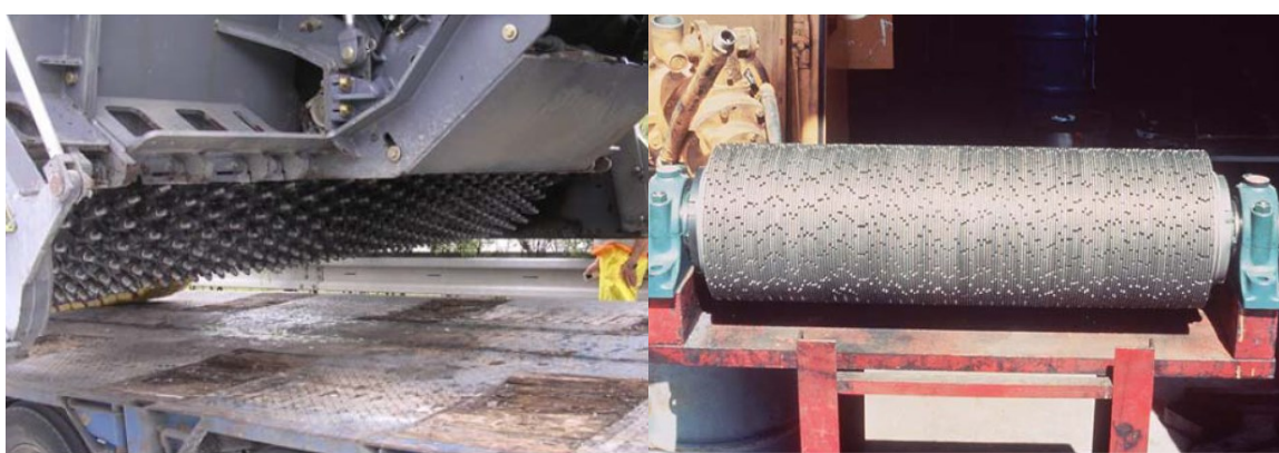
Obr. 11 Vlevo hlava frézy, vpravo brusný kotouč [64]
