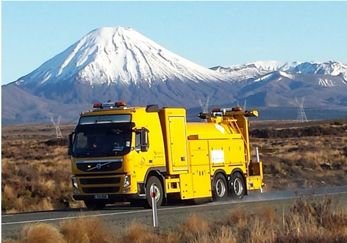
Obr. 23 Měřící vozidlo SCRIM [16]
