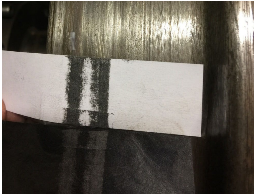
Obrázek 18 – Místo reálného otěru vzorku maziva v kontaktu kola a kladky
