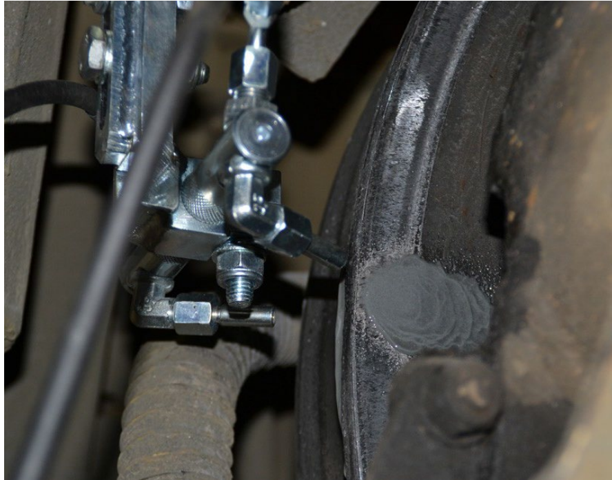
Obrázek 2 – Mazání okolků vozidla kapalným mazivem TRIBOTEC [2]
