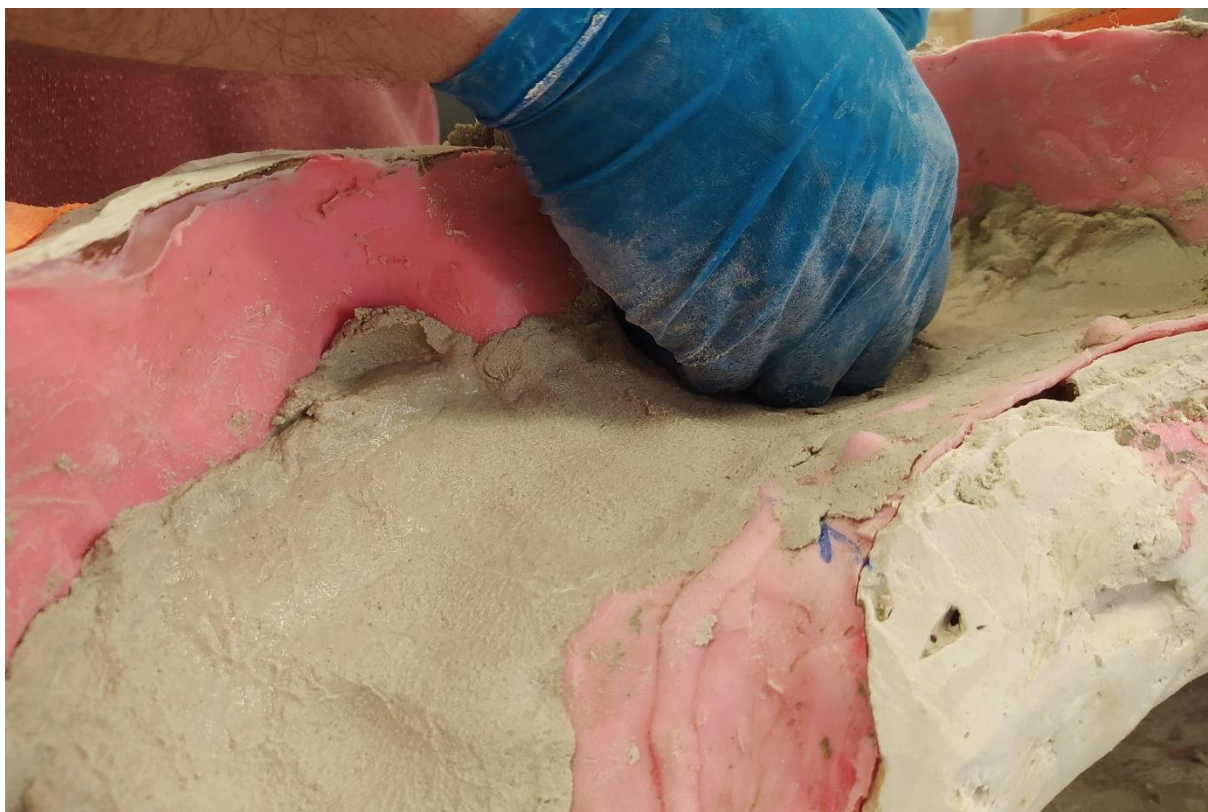
obr. 55 Aplikace směsi umělého pískovce do formy.
