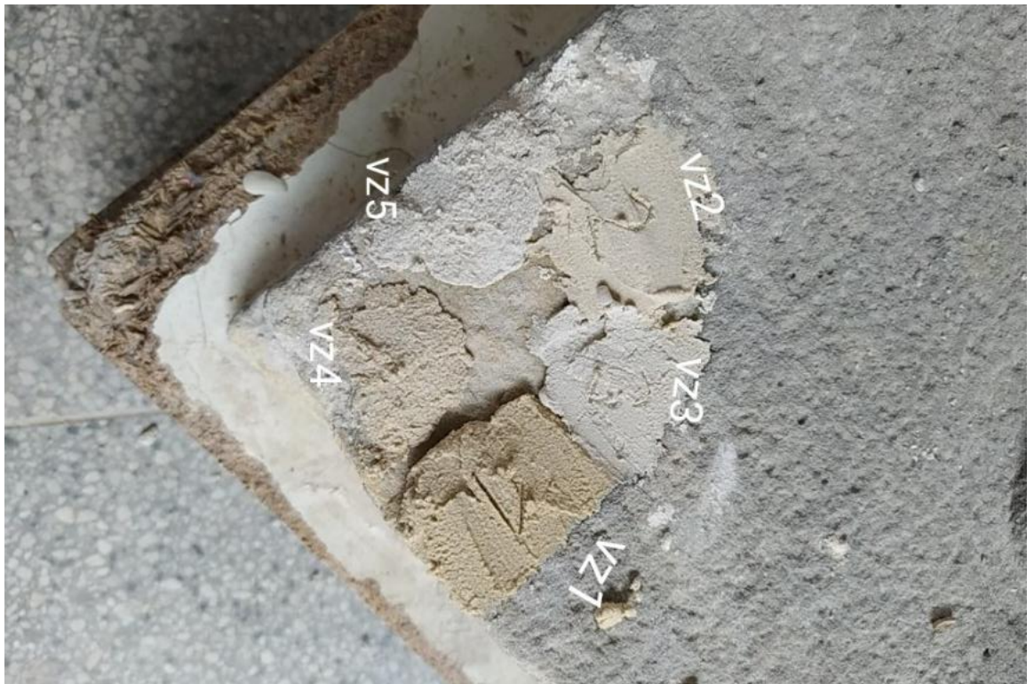
obr. 21 Fotografie zkoušek tmelů.
