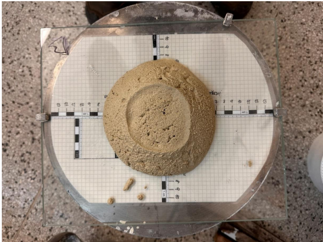
obr. 7 Stanovení rozlivu na střešacím stolku. Rozlití koláče a měření průměru ve dvou kolmých směrech pomocí měřitek.
