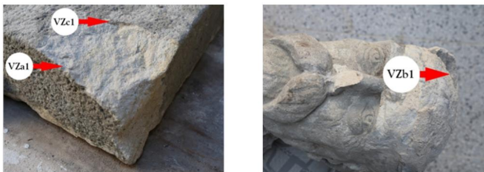
Obr. 2 a, b: Snímky míst odběru vzorků pro chemicko-technologický průzkum. Vzorky VZa1 a VZc1 byly odebrány ze soklu, vzorek tmelu VZb1 z hlavy, pod čepicí. Foto Marek Knot, FR, UPa.
