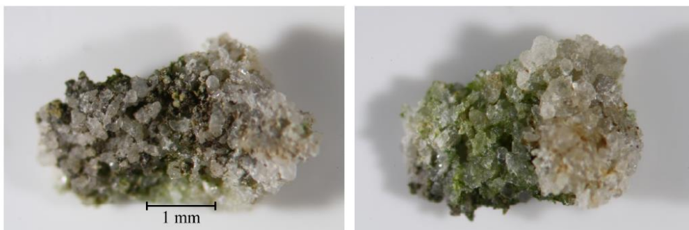
Obr. 5: Makrosnímky odebraného vzorku ze stereomikroskopu v odraženém světle při zvětšení 20x: (vlevo) líc a (vpravo) rub vzorku. Povrchová vrstva netvoří souvislou překryvnou vrstvu, ale spíše lokální tmavé ostrůvky. Kromě nich jsou na povrchu podobně distribuovány zelené řasy.
