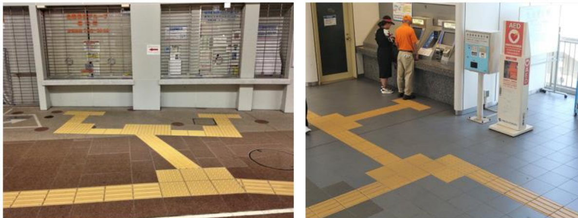
Obr. 3-1 Hmatové prvky v Japonsku: a) odbavovací hala žst. Higashi-Kanazawa; b) nádraží Kanda
