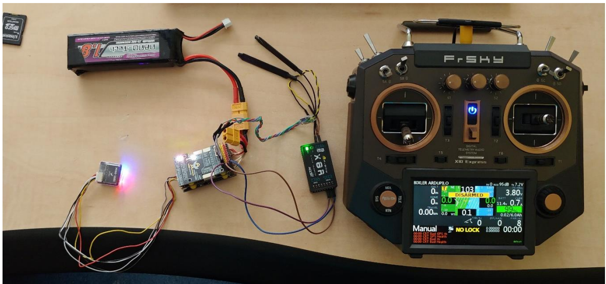
obr. 31 - přenosová soustava, zleva: GPS modul, letový počítač, přijímač, vysílač
