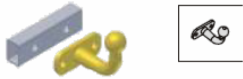
Obr. 3.13: Dvoušroubový systém II [9]
