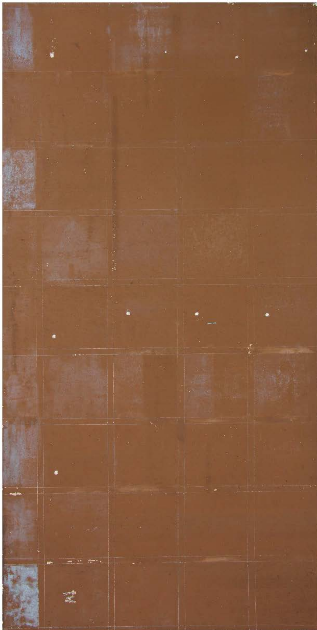
Obr. 19: Panel 1; barevná vrstva po konsolidaci vápennými nanosuspensemi.
