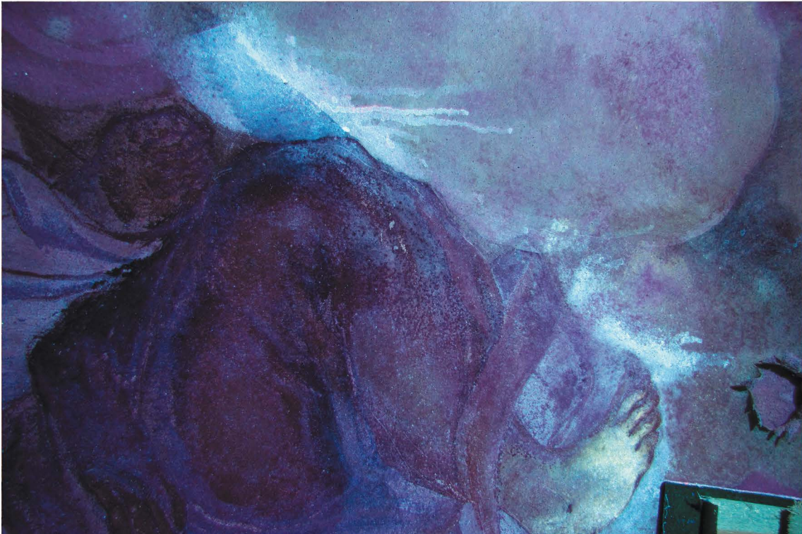
Obr. 44: Fotografie v UV světle. Viditelná je bledě modrá luminescence zateklin fixáže.
