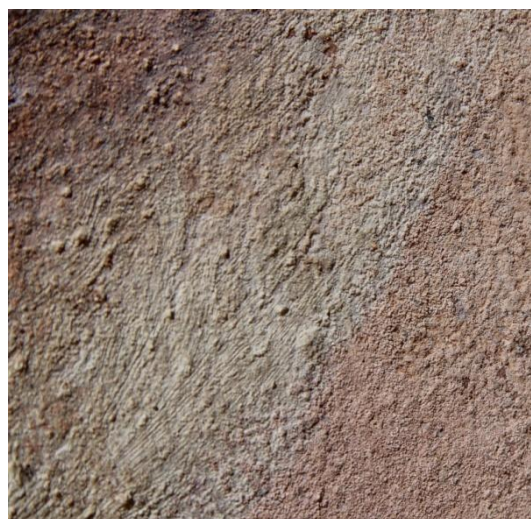
Obr. 16: Barevná vrstva po konsolidaci CaLoSiLem E25 při 10 g/l.
