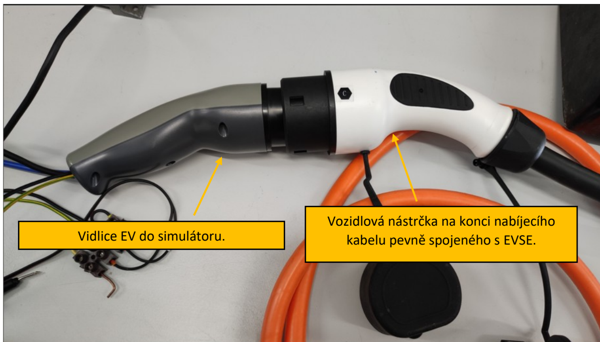
Obrázek 27 - Nefunkční zapojení kabelu typu 2
