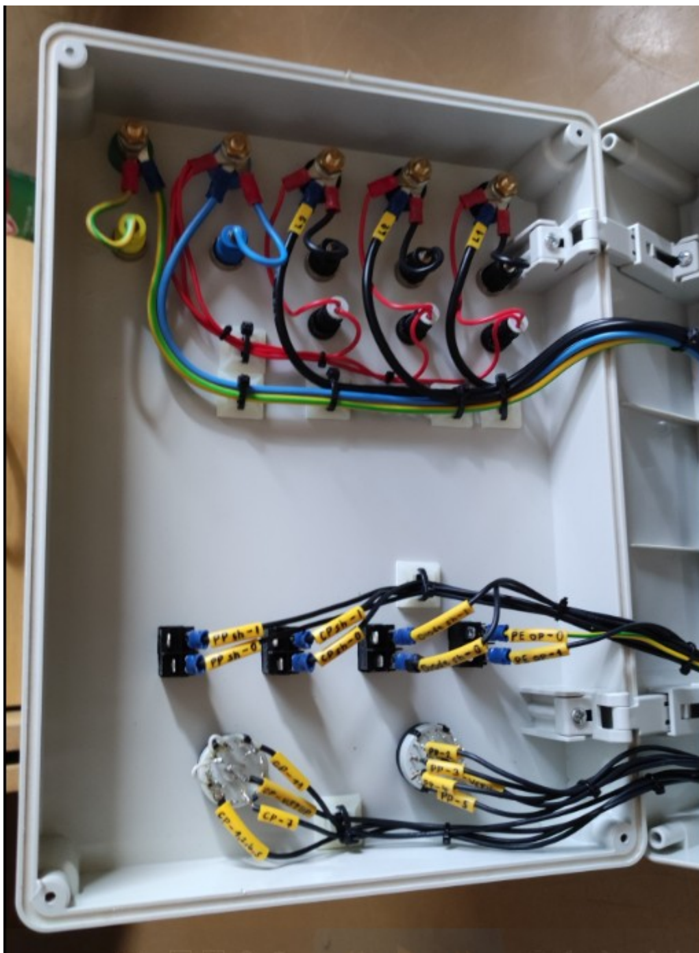
3.3 – Simulátor pro režim nabíjení 3B - pohled po otevření na vnitřní stranu víka
