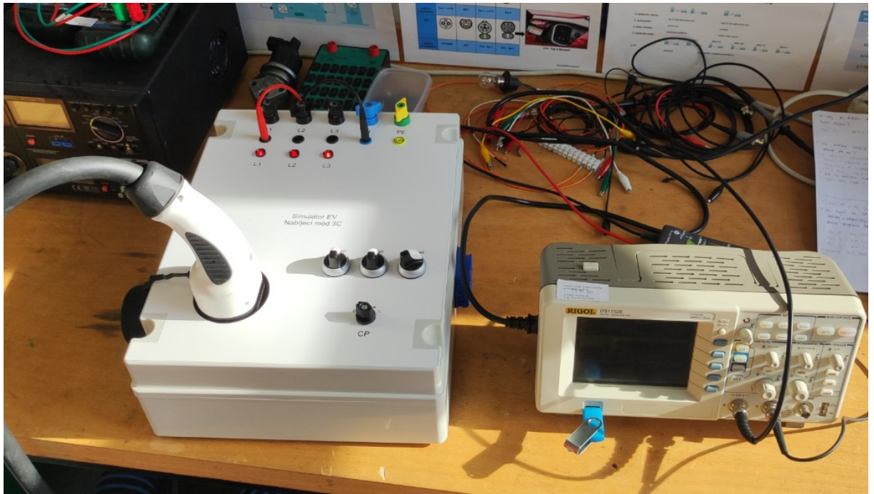
3.10 – Simulátor pro režim nabíjení 3C – propojení simulátoru s nabíjecím kabelem (režim nabíjení 2)
