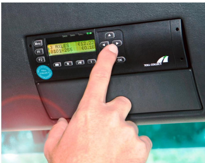
Obrázek 13 – Palubní jednotka systému Toll Collect určená pro vestavbu do slotu DIN
