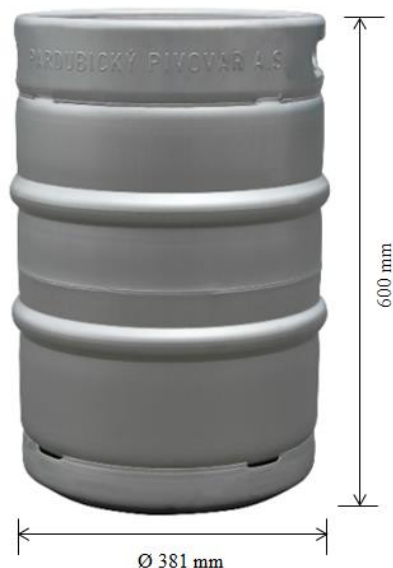
Obrázek 9 Rozměry pivního sudu KEG (Pardubický pivovar a.s., 2017)
