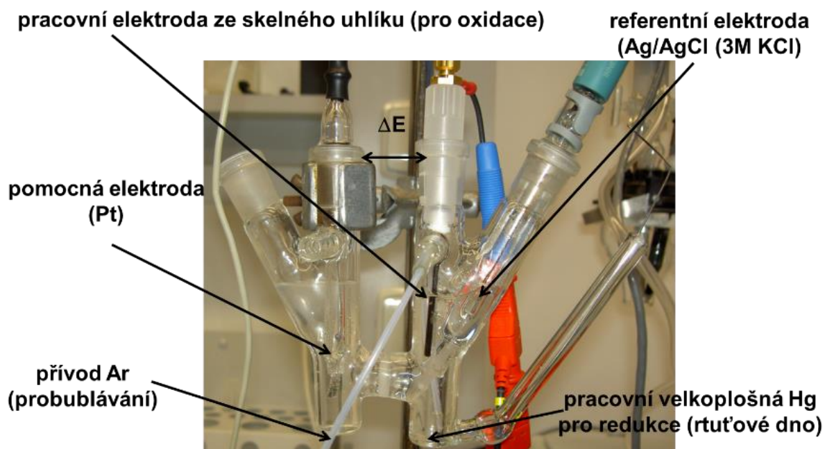
Obr. 3 Ukázka H cely pro preparativní elektrolýzu
