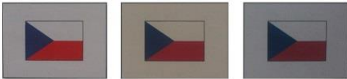
Obrázek 11 - Jedna a táž barva definována hodnotami CMYK na různých papírech
