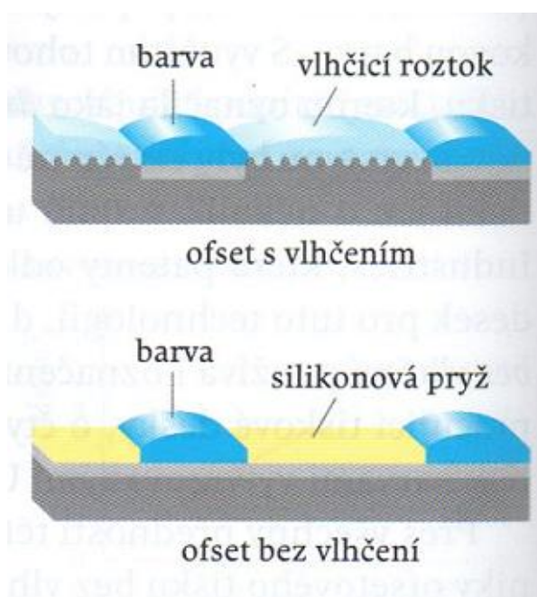
Obrázek 14 - Schéma ukládání tiskové barvy na tiskové formě v ofsetovém tisku s vlhčením a bez vlhčení
