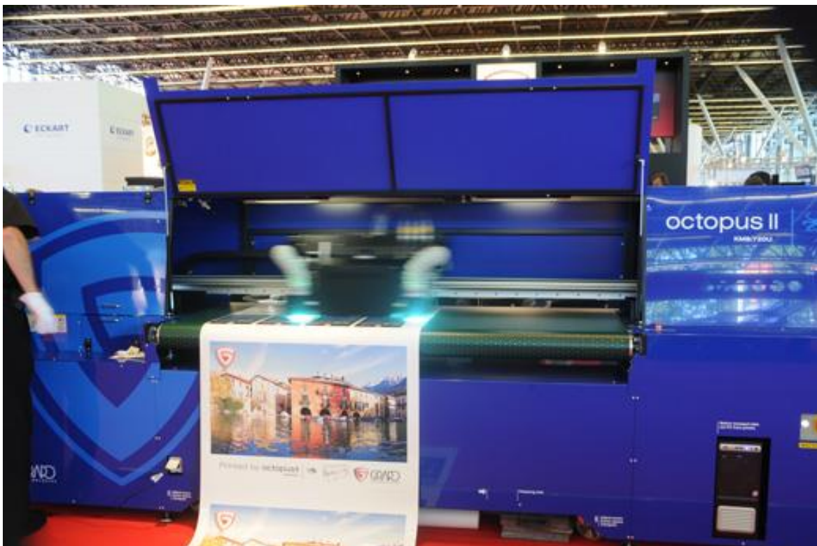
Obrázek 24 - Inkjetová UV tiskárna Octopus II
