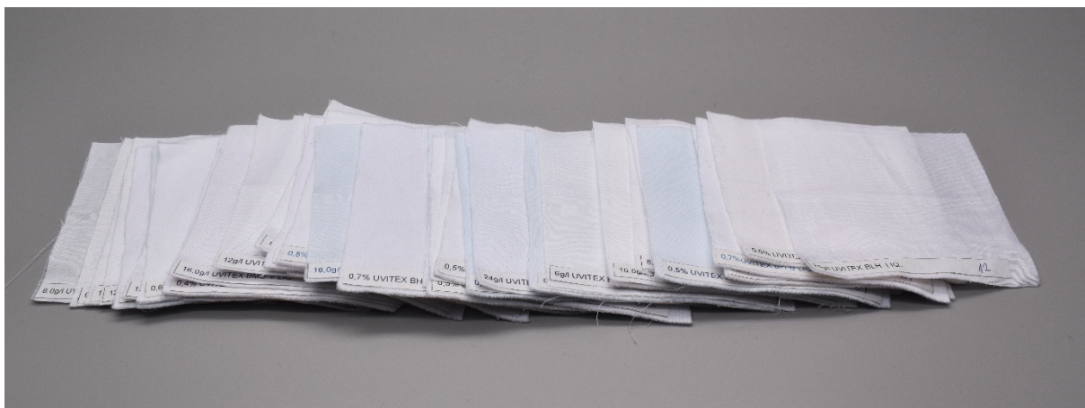
Obrázek 16: Sada hodnocených textilních vzorků v koloristické skříni pod simulátorem osvětlení D50
