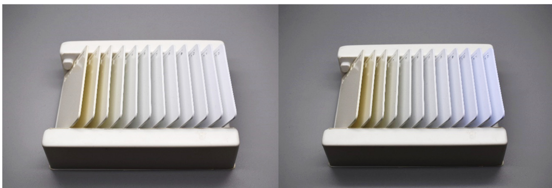
Obrázek 8: Plastová stupnice CIBA pod simulátorem osvětlení D50 (vlevo) a D50 se zesílenou složkou UV (vpravo)
