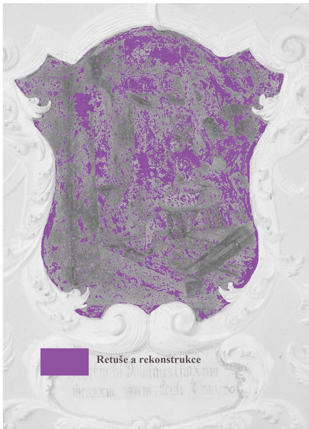
Obr. 65. Grafická dokumentace znázorňující provedené retuše a rekonstrukce
