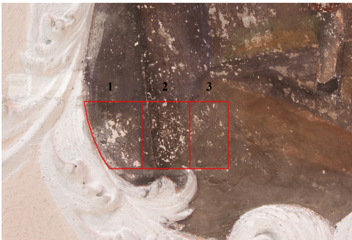
Obr. 72. Zkoušky čištění: 1 - čištění mikroporézní houbou namočenou ve vodě 2 - čištění citrátem amonným o 5% koncentraci, aplikace pomocí štětce s jemným vlasem 3 - čištění pomocí rozpouštědlového gelu z Carbopolu ® EZ-2 a směsi acetonu s vodou
