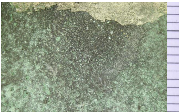
Obr. č. 82 Vzorka 3/1: Tryskanie orechovými škrupinkami
