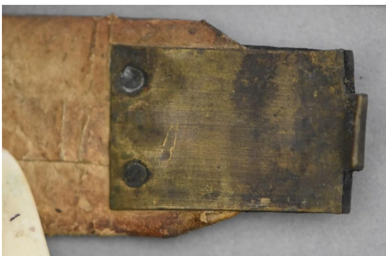
Obr.č. 11 – Ukážka valcovaného plechu. Z neskoro gotickej knižnej väzby z roku 1514. Zobrazená je vnútorná časť spony. Prúžky po valcovaní sú viditeľné na oboch stranách. Sign. I F α 18
