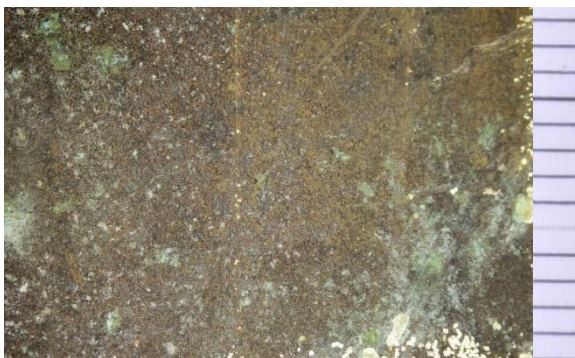
Obr. č. 86 Vzorka 8/4: Čistenie laserom
