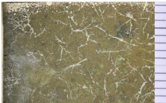
Obr. č. 80 Vzorka 1/1: Čistenie skleneným vlákno za sucha
