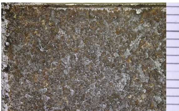
Obr. č. 119 Vzorka 5/1: Konzervovanie včelím voskom
