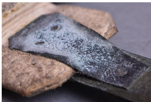
Obr. č. 78 Ďalšie príklady poškodenia koróziou spôsobenou chloridovými iónmi. Sign. XX B \beta 1, XIX A 5
