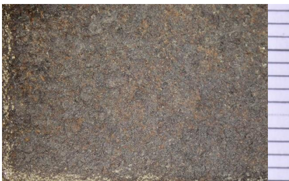
Obr. č. 123 Vzorka 10/3: Konzervovanie akrylátovým lakom
