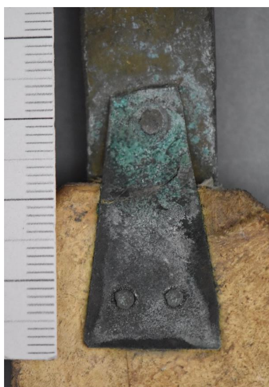
Obr. č. 77 Poškodenie spony koróziou spôsobenou chloridovými iónmi. Sign. I F \alpha 9
