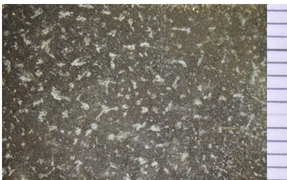
Obr. č. 92 Vzorka 13/1: Čistenie 5 % Chelatonom III
