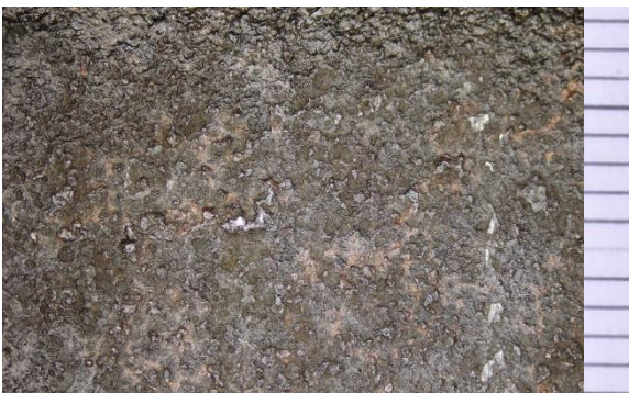
Obr. č. 109 Vzorka 3/1: Stabilizácia 20 % taninom s 5 % liehu (2 vrstvy)
