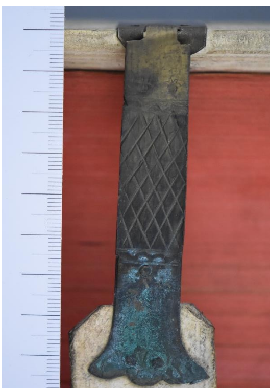
Obr. č. 77 Poškodenie spony koróziou spôsobenou chloridovými iónmi. Sign. I F \alpha 9
