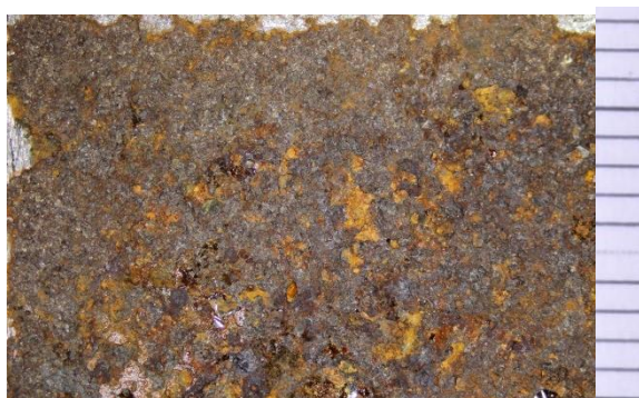
Obr. č. 109 Vzorka 3/1: Stabilizácia 20 % taninom s 5 % liehu (2 vrstvy)
