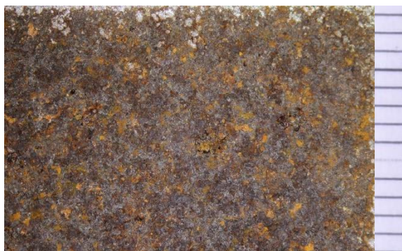
Obr. č. 107 Vzorka 2/2: Stabilizácia 5 % kyselinou fosforečnou
