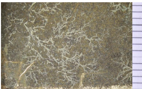
Obr. č. 81 Vzorka 2/3: Čistenie skleneným vláknom za mokra
