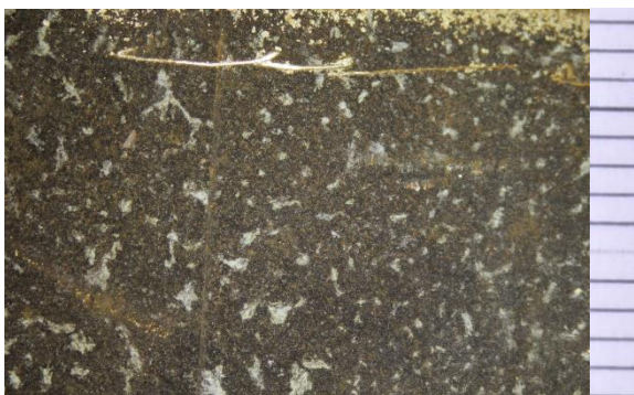
Obr. č. 91 Vzorka 12/2: 8% kyselina sírová 3 % (30 %) s \text{H}_2\text{O}_2
