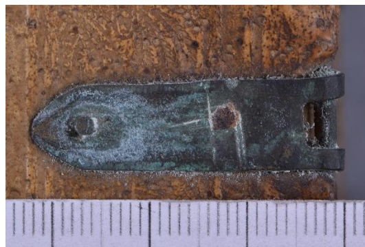
Obr. č. 78 Ďalšie príklady poškodenia koróziou spôsobenou chloridovými iónmi. Sign. XX B \beta 1, XIX A 5
