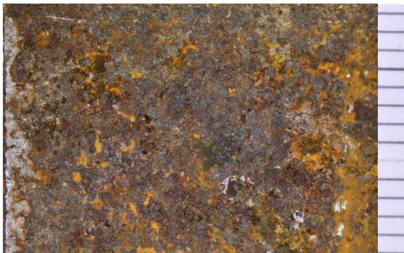
Obr. č. 101 Vzorka 6/1: Tryskanie balotinou
