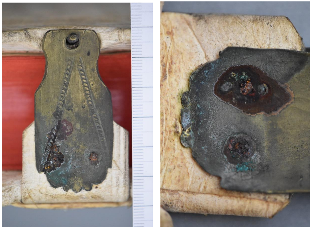
Obr. č. 75 vznik galvanického článku Sign I E \alpha 3
