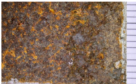
Obr. č. 110 Vzorka 16/4: Stabilizácia 20 % taninom s 5 % liehu (1 vrstva)
