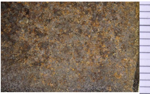
Obr. č. 102 Vzorka 10/4: Tryskanie orechovými škrupinkami
