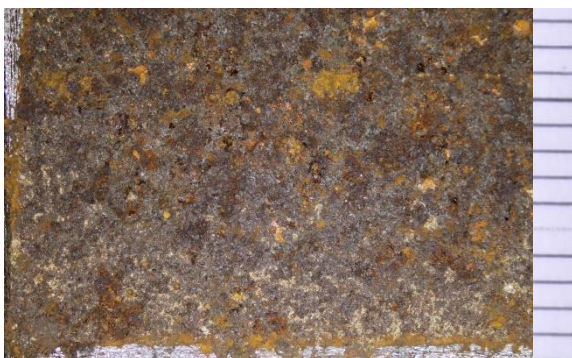
Obr. č. 112 Vzorka 1/3: Stabilizácia 3 % kyselinou dekanovou
