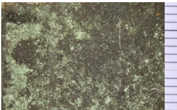
Obr. č. 88 Vzorka 9/1: Čistenie 5 % kyselinou sírovou
