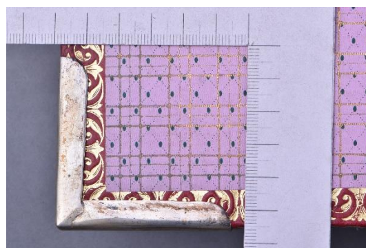
Obr. č. 66 Fixácia nárožného kovania – zahnutím plechu na hranách dosiek smerom na vnútornú stranu dosiek.
