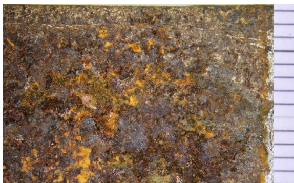
Obr. č. 108 Vzorka 6/2: Stabilizácia 5 % kyselinou fosforečnou
