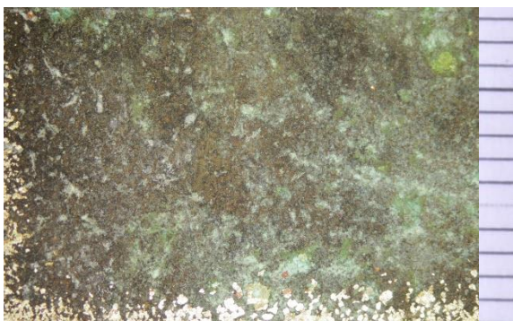
Obr. č. 83 Vzorka 4/3: Tryskanie orechovými škrupinkami
