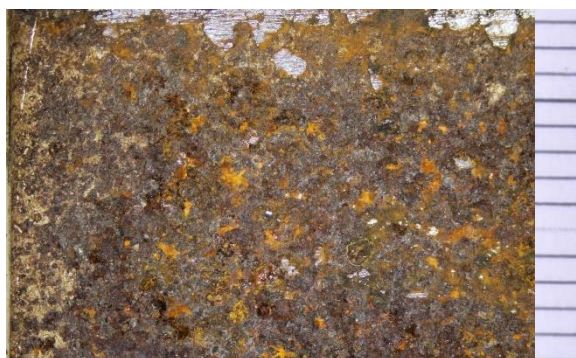
Obr. č. 104 Vzorka: 14/1: Čistenie laserom
