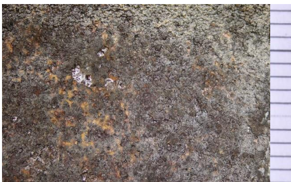
Obr. č. 121 Vzorka 16/2: Konzervovanie mikrokryštalickým voskom
