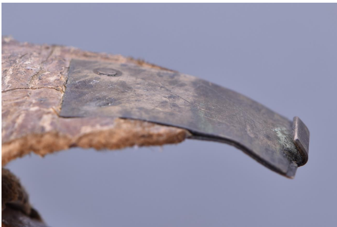
Obr. č. 68 Deformácia spony zapríčinená zmrštením usňového remienka a následným nevhodným uložením. Sign. I F 18
