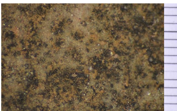
Obr. č. 114 Vzorka 14/1: Konzervovanie včelím voskom
