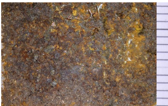
Obr. č. 111 Vzorka 4/3: Stabilizácia 3 % kyselinou dekanovou
