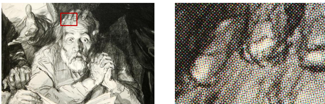
Obr. 64 – Detail archového ofsetu ze čtyř barev, velikost jednoho obrázku 20,6 x 24,5 cm, vpravo při zvětšení 10x
