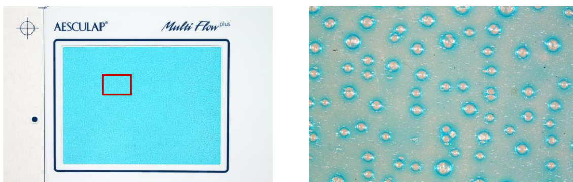
Obr. 66 – Detail technického sítotisku, skutečná velikost 17 x 26 cm, vpravo při zvětšení 10x
