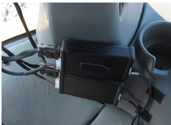
Obrázek 5.9 – Umístění GSM modemů za sedadlem
