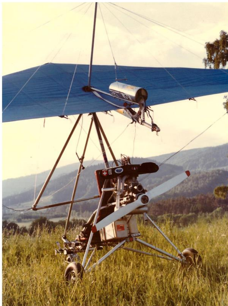
Obrázek 1: Rok 1984 motorové rogallo MZK - 2 s prvním balistickým systémem
