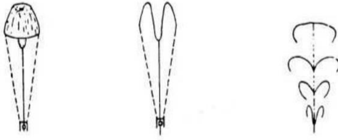
Obrázek 5: Otevírání ZS pomocí středové šňůry
