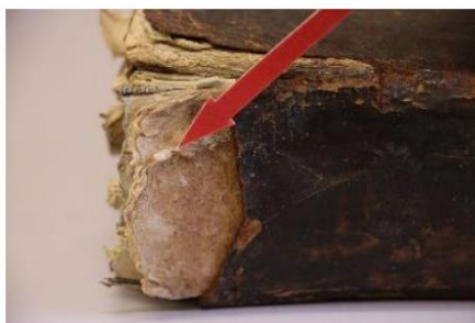
Místo odběru (fotografie Adriana Sabolová) a makrosnímek vzorku AS2/11508. Fotografováno na stereomikroskopu SMZ 800, bílé dopadající světlo, zvětšení na mikroskopu 20x.
