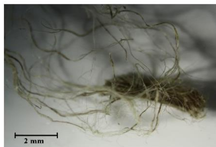
Místo odběru (fotografie Adriana Sabolová) a makrosnímek vzorku AS4/11510. Fotografováno na stereomikroskopu SMZ 800, bílé dopadající světlo, zvětšení na mikroskopu 10x.
