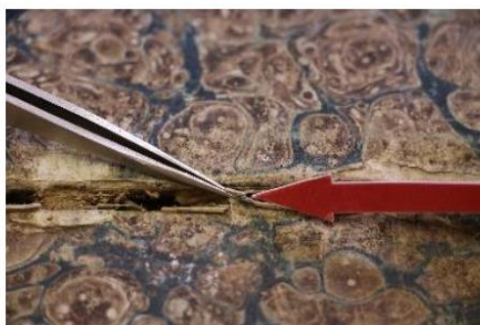
Místo odběru (fotografie Adriana Sabolová) a makrosnímek vzorku AS3/11509. Fotografováno na stereomikroskopu SMZ 800, bílé dopadající světlo, zvětšení na mikroskopu 20x.
