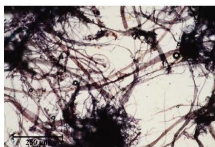
Snímek vláken vzorku AS3/11509 v Herzbergově činidle. Fotografováno na optickém mikroskopu Nikon ECLIPSE LV100 při zvětšení na mikroskopu 50x, 100x a 200x v bílém procházejícím světle.
