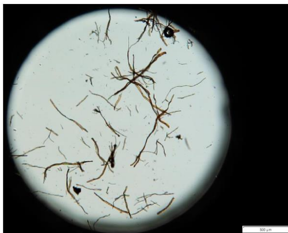
Obr. 2 Vzorek v měřící cele FP82, před měřením teploty smršťení
