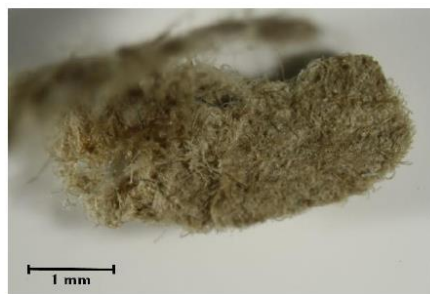
Místo odběru (fotografie Adriana Sabolová) a makrosnímek vzorku AS2/11508. Fotografováno na stereomikroskopu SMZ 800, bílé dopadající světlo, zvětšení na mikroskopu 20x.
