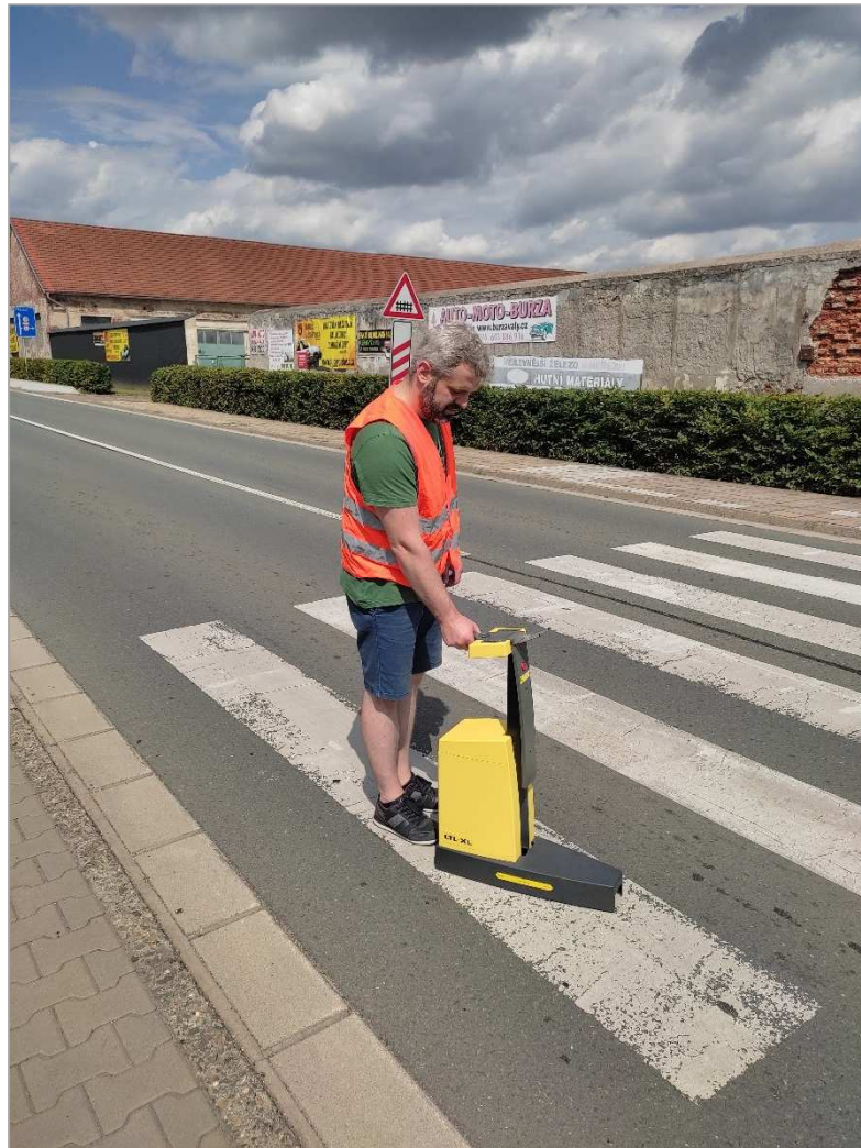
Obrázek 24 – Měření VDZ in-situ – Silnice I/2 Valy – průtah [vlastní]
