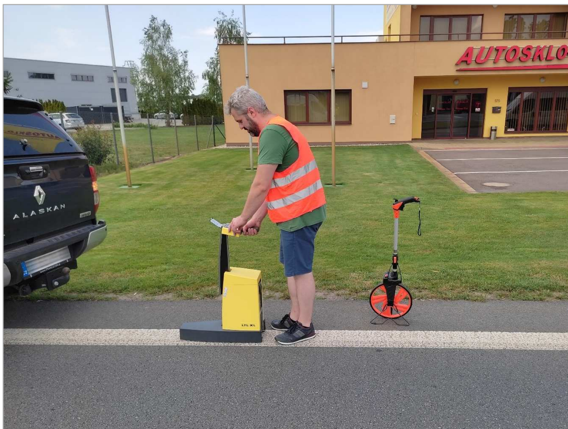
Obrázek 14 – Měření in-situ s přístrojem DELTA LTL-XL [vlastní]
