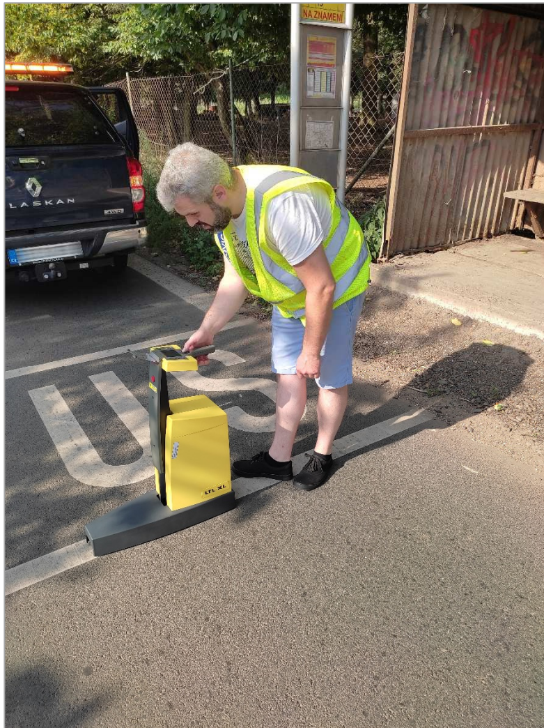
Obrázek 21 – Měření VDZ in-situ – Silnice III/299 12 HK, Věkoše – Správcice [vlastní]
