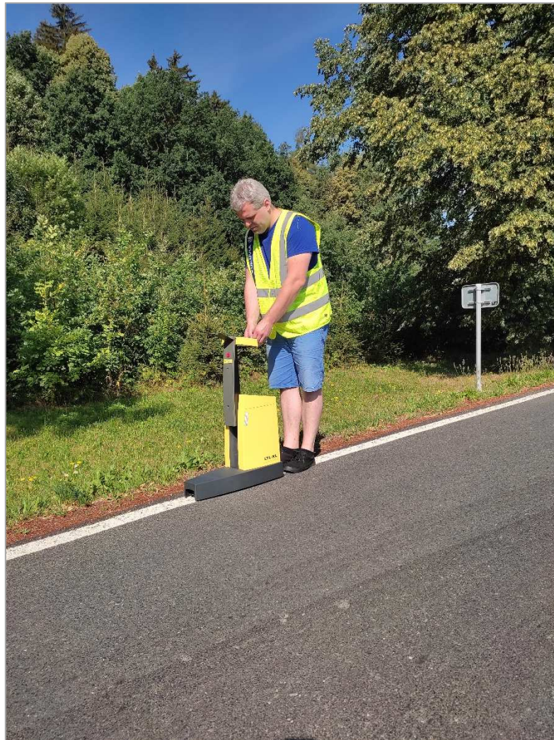
Obrázek 18 – Měření VDZ in-situ – Silnice II/368 Krasíkov – průtah [vlastní]
