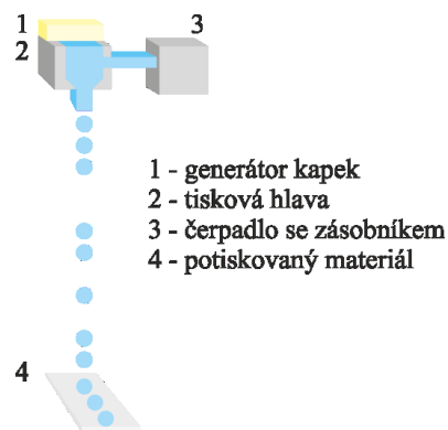
Obrázek 5 Princip digitální techniky – drop-on-demand
