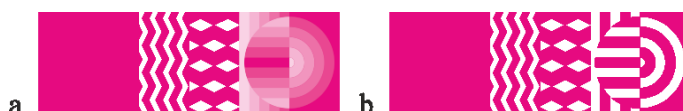
Obrázek 27 Testovací obrazce vytvořené pro zkoumání odolnosti vůči praní; a – obrazec pro tiskové techniky podporující polotóny, b – obrazce umožňující pouze tisk plných ploch
