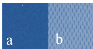
Obrázek 14 Detail barvy PANTONE Process Blue C na přenosovém papíře; a – před přenosem na tkaninu, b – po přenosu na tkaninu
