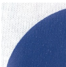
Obrázek 22 Detail vytištěného motivu s jasně viditelnou vrstvou tištěné barvy a struktury tkaniny
