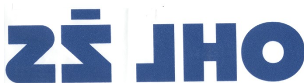
Obrázek 20 Transferový tisk zhotovený plastizolovými barvami s naprášeným lepidlem po průchodu horkovzdušným tunelem na přenosovém papíře
