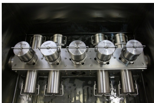
Obrázek 31 Otáčecí hřídel testovacího zařízení Gyrowash 815 s umístěnými nerezovými nádobami s testovanými vzorky
