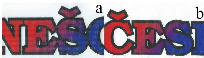
Obrázek 25 Ukázka potisku textilu zhotoveného potištěnou fólií; a – ukázka fólie před tiskem, b – ukázka fólie přenesené na tkaninu
