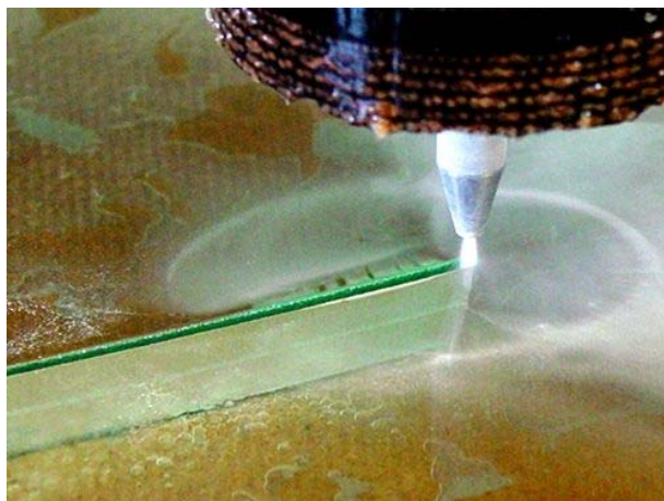
Obr. 10 Detail řezu vrstveného skla vodním paprskem.
