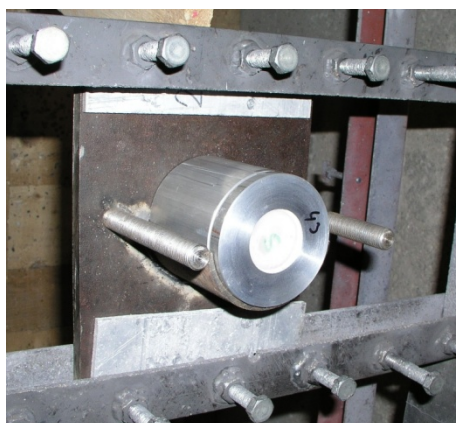
Obr. 6 Uložení terče do stojanu při střeleckých zkouškách
