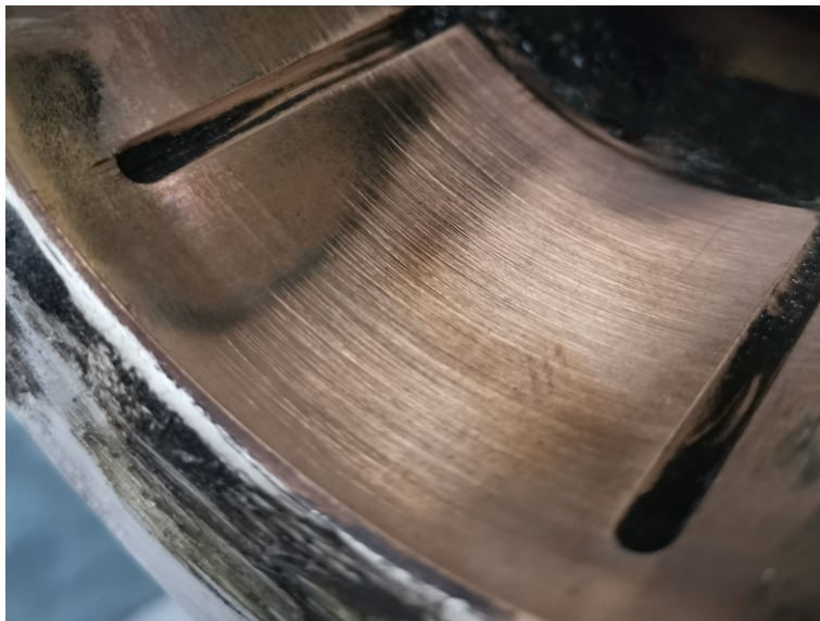
Obrázek 4 Provozně opotřebené pouzdro ložiska (Archiv CSAT, 2024)
