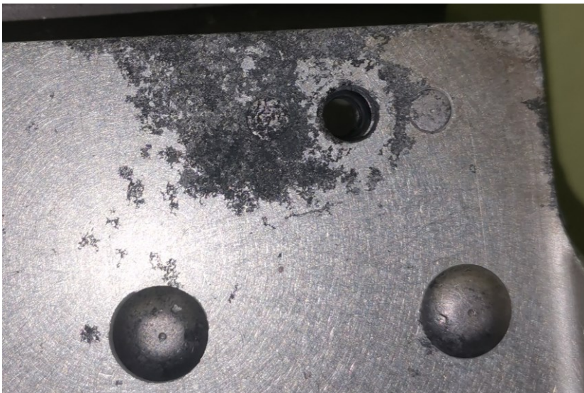
Obrázek 7 Povrchová koroze duralového plechu (Archiv CSAT, 2024)
