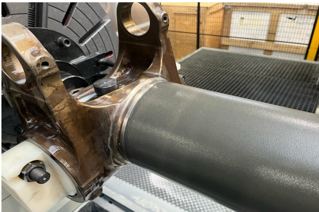
Obrázek 15 Povrch vnitřního válce po žárovém nástřiku niklem (Archiv CSAT, 2024)
