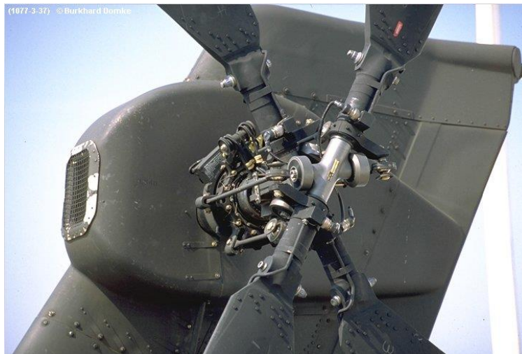
Obrázek 19 Neortogonální rozložení listů vyrovnávacího rotoru AH-64 Apache [37]
