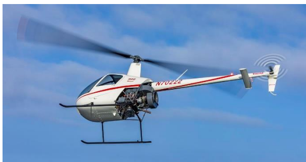
Obrázek 9 Vrtulník Robinson R22 s dvoulistým ocasním rotorem [21]
