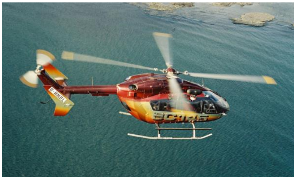
Obrázek 12 Vrtulník EC 145 T1 s dvoulistým ocasním rotorem na vrcholu svislého stabilizátoru [23, s. 46]
