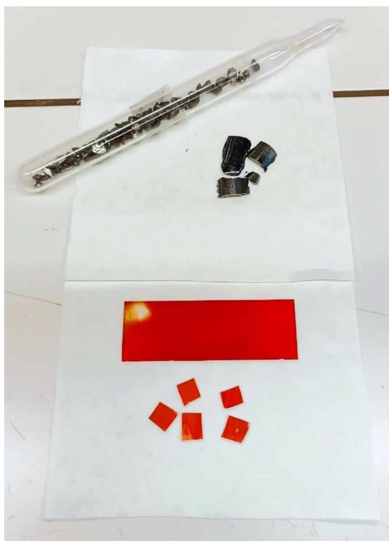
Obrázek 9 – Ampule s naváženými prvky, objemové vzorky skla a tenká vrstva složení \text{Ge}_{20}\text{Se}_{80}
