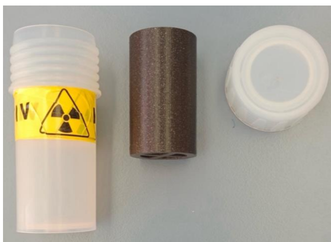
Obrázek č.13: Měřicí nádoba s neaktivním plastem pro stlačení (zdroj: mjr. doc. Ing. Jiří Janda, Ph.D.; Univerzita obrany Vyškov)
