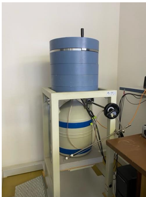
Obrázek č.15: HPGe detektor s chlazením a stíněním
