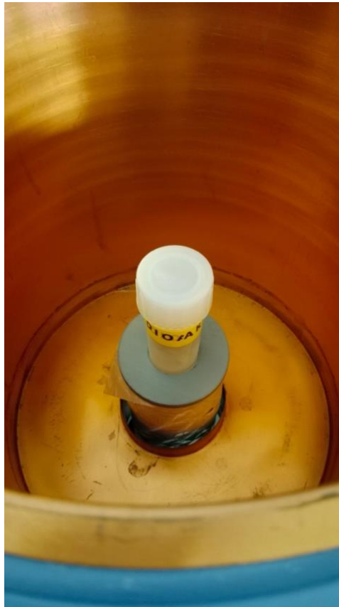
Obrázek č.14: Měřící nádoba se vzorkem v HPGe (zdroj: mjr. doc. Ing. Jiří Janda, Ph.D.; Univerzita obrany Vyškov)
