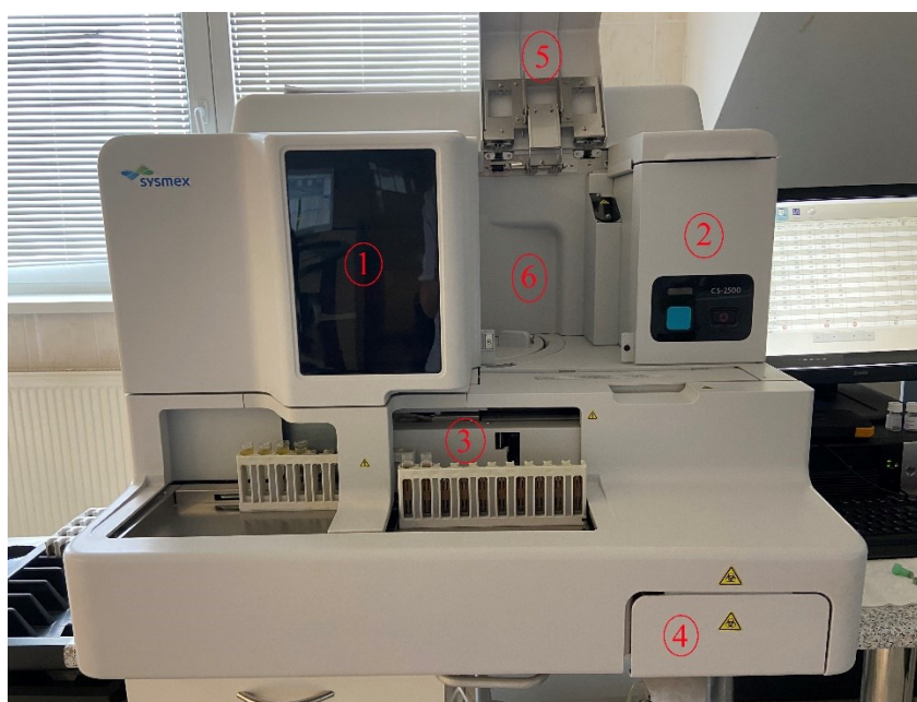
Obr. 11: Sysmex CS 2500 (pohled zepředu) (1 – kryt v oblasti pohybu reagenční jehly, 2 – zásobník reakčních kyvet a panel umožňující spuštění a nouzové zastavení stroje, 3 – oblast pro vkládání stojanů se vzorky, 4 – zásuvka pro použité reakční kyvety, 5–6 – kryt měřící části)
