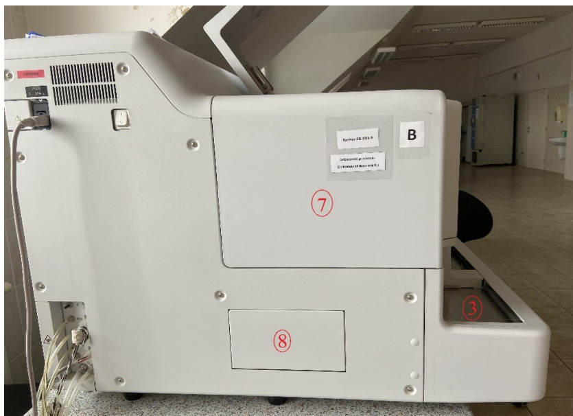
Obr. 12: Sysmex CS 2500 (pohled ze strany) (3 – oblast pro vkládání stojanů se vzorky, 7 – boční strana krytu oblasti pohybu reagenční jehly, 8 – kryt s ventilem systému a ovladačem pohotovostního nastavení vakua)
