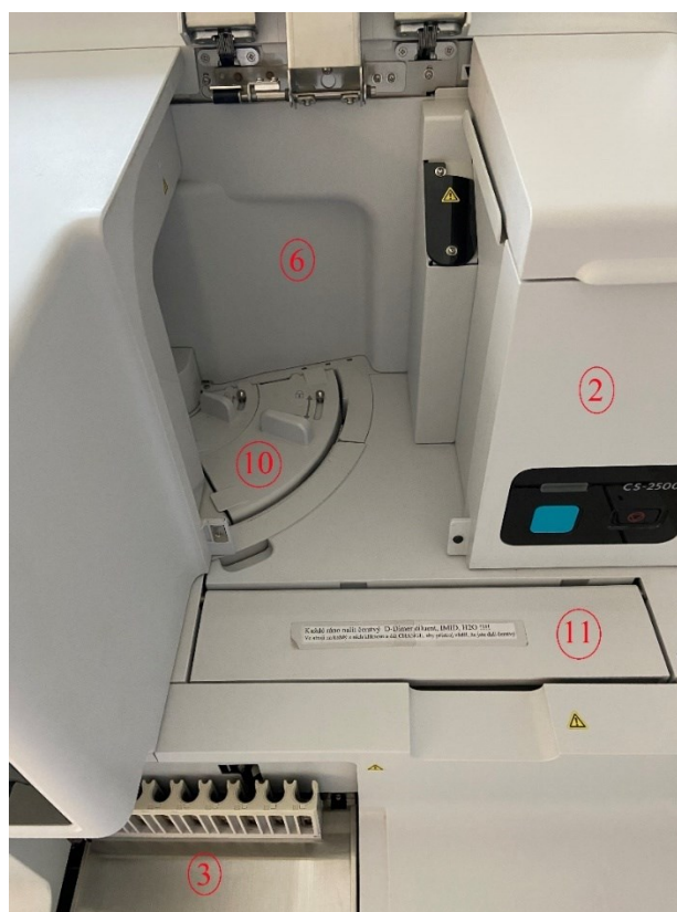
Obr. 13: Sysmex CS 2500 (pohled dovnitř) (2 – zásobník reakčních kyvet a panel umožňující spuštění a nouzové zastavení stroje, 3 – oblast pro vkládání stojanů se vzorky, 6 – kryt měřící části, 10 – kryt vstupu do reagenční části, 11 – krycí část pro diluenty)
