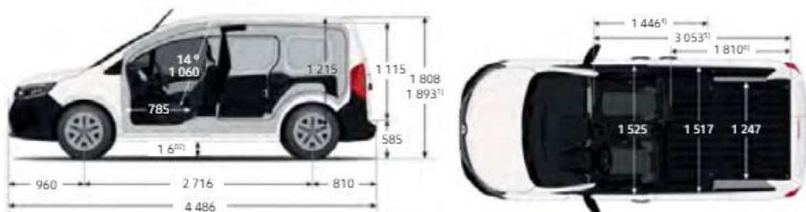
Obrázek 10 Rozměry nákladového prostoru Renault Kangoo Van E-tech
