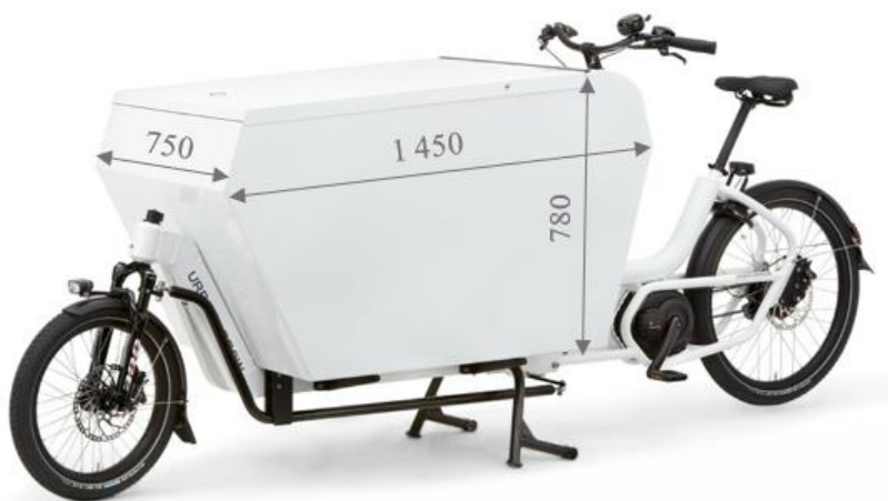
Obrázek 12 Rozměry nákladového prostoru Urban Arrow Cargo XL ALU BOX
