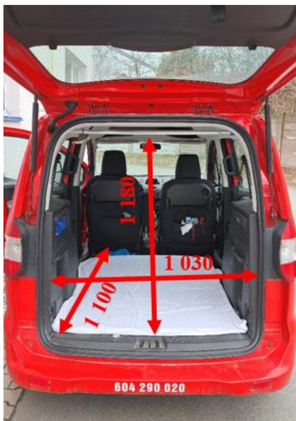
Obrázek 3 Rozměry nákladového prostoru Ford Tourneo Courier
