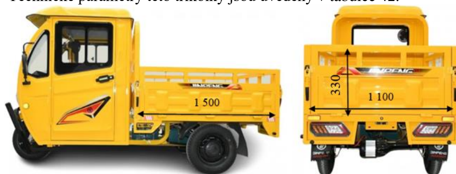
Obrázek 14 Rozměry nákladového prostoru Cargo TJ150
