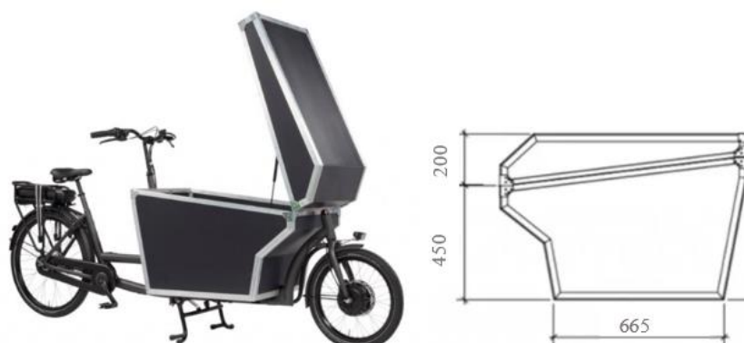
Obrázek 13 Rozměry nákladového prostoru Professional Dolly Cargo
