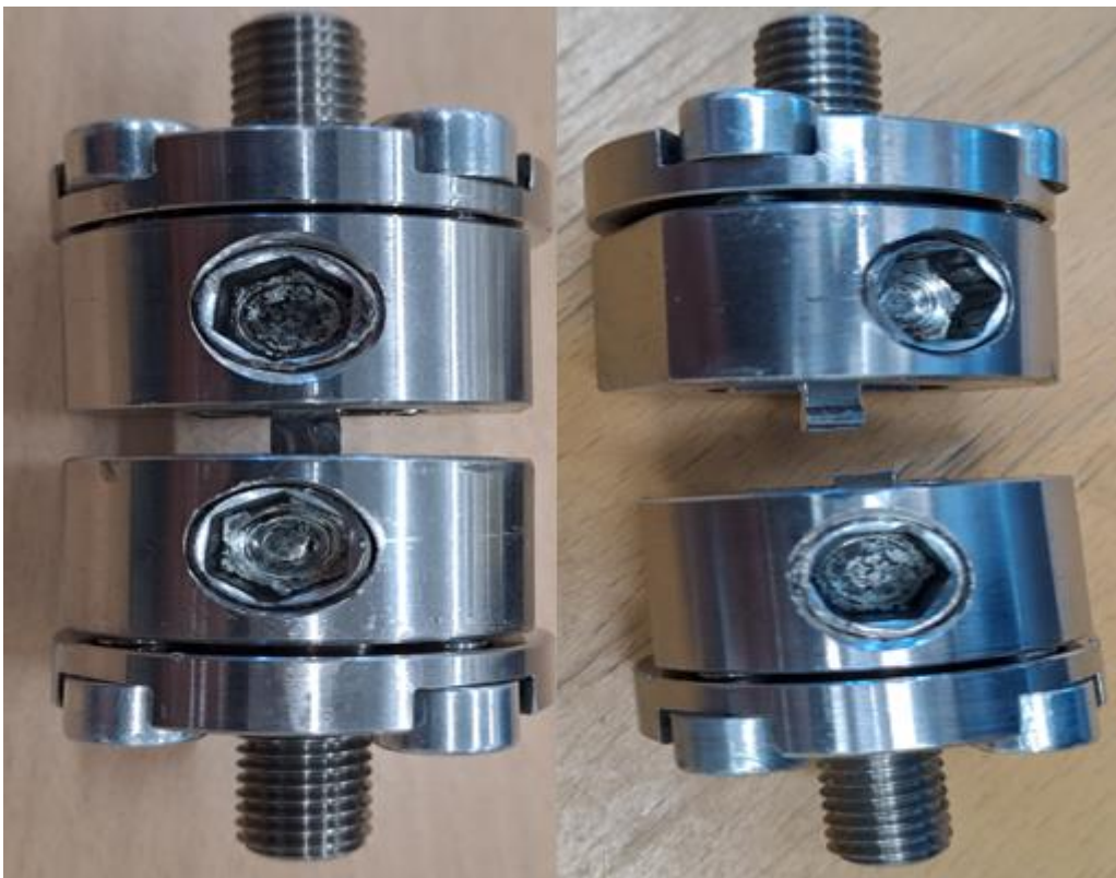
Obrázek 29.: Zkušební vzorek v kleštině před a po dynamické tahové zkoušce
