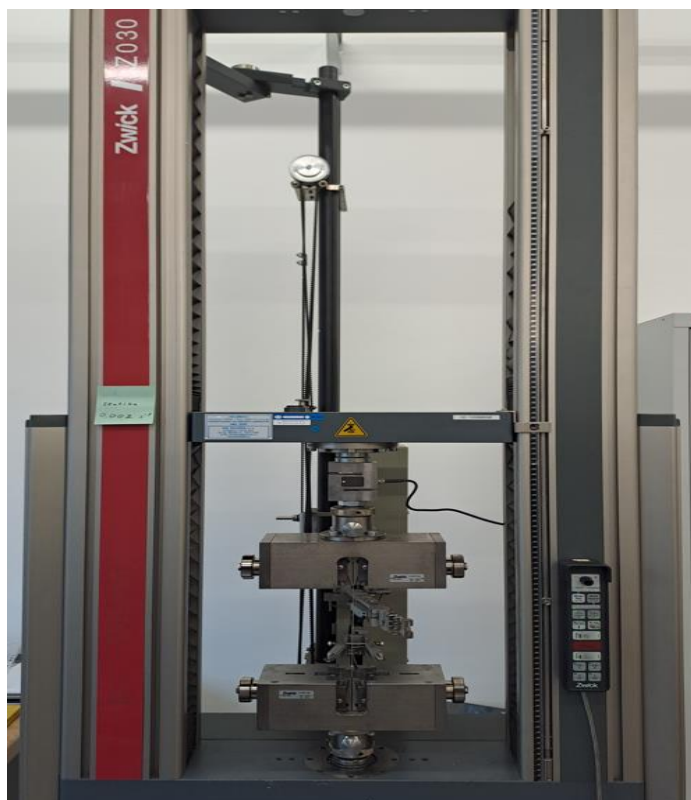
Obrázek 25.: Zkušební stroj Zwick/Roell typu Z030
