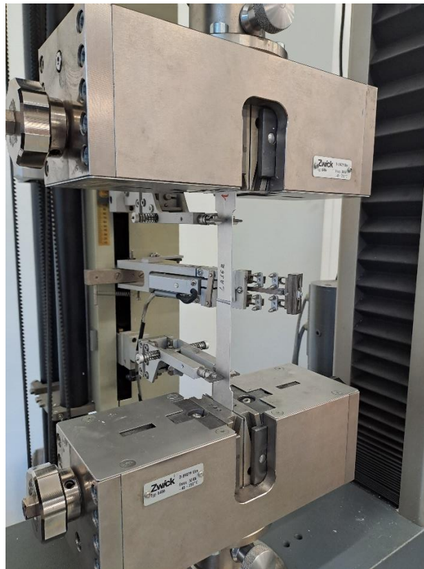
Obrázek 27.: Zkouška tahem na stroji Zwick/Roell typu Z030
