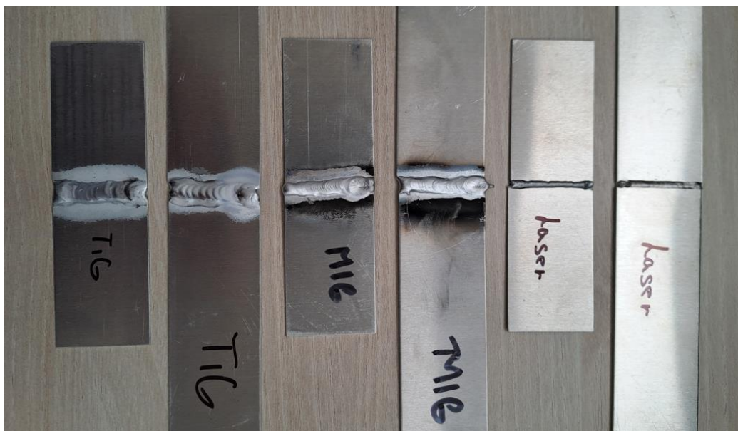
Obrázek 22.: Svařené zkušební vzorky metodami TIG, MIG, Laser
