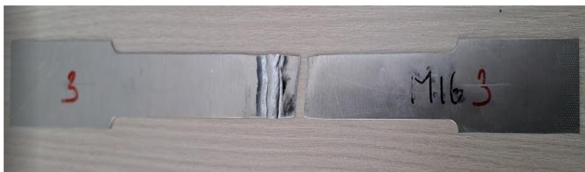
Obrázek 28.: Zkušební vzorek č. 3 – metoda svařování MIG
