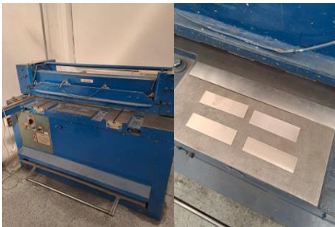
Obrázek 18.: Tabulové nůžky od fi. Digep – příprava vzorků pro svařování
