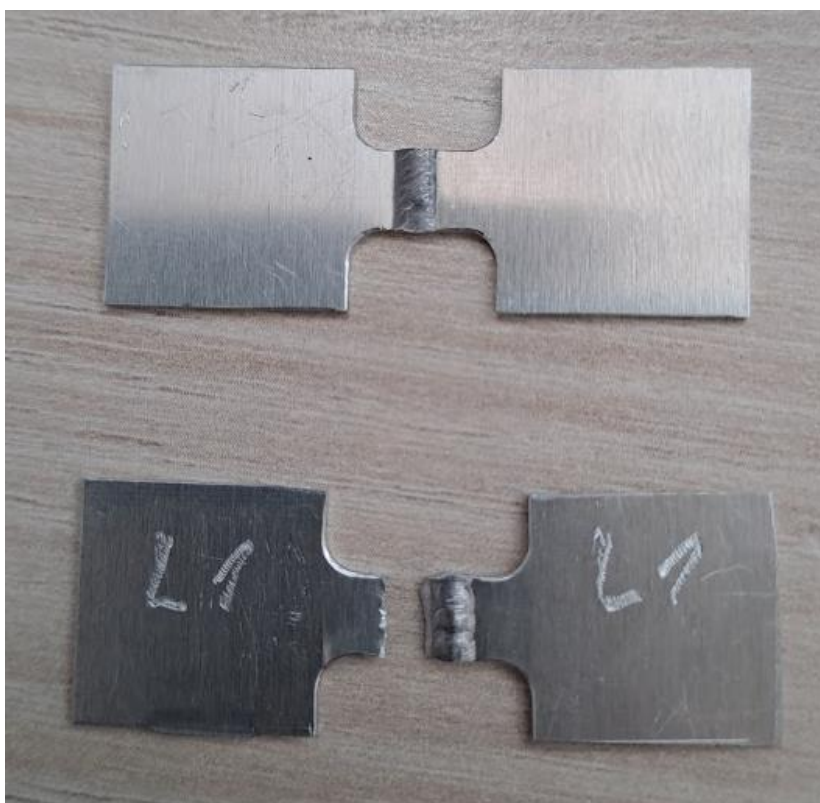
Obrázek 30.: Zkušební vzorek před a po dynamické tahové zkoušce
