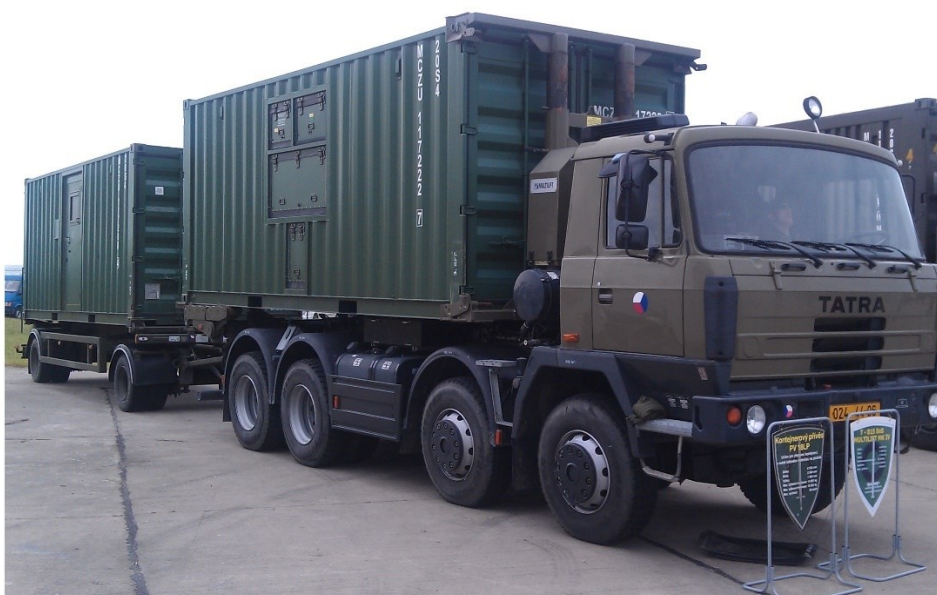
Obrázek 19 Kontejnerový nakladač Tatra 815 MK IV Multilift s přívěsem PV 18 LP (Válka.cz, 2012)
