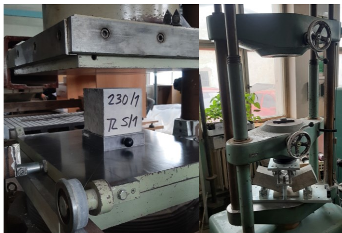
Obrázek 30: Pevnostní zkoušky ztvrdlého betonu
