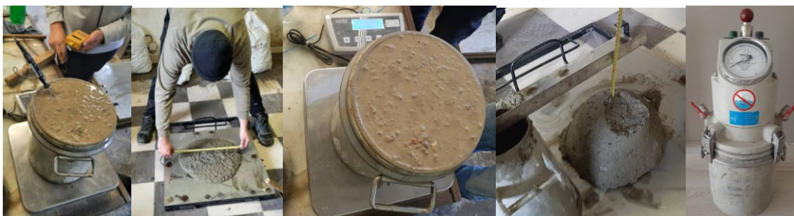
Obrázek 29: Zkoušky čerstvého betonu
