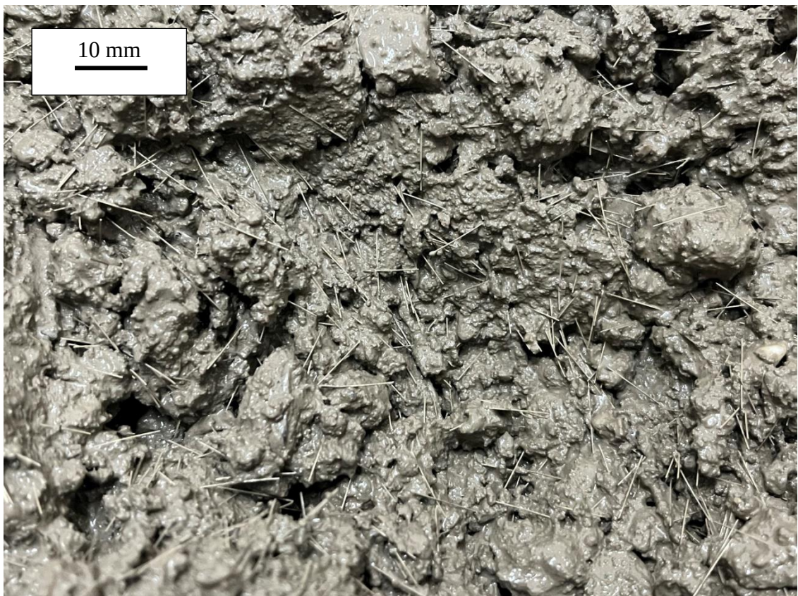
Obrázek 21 Masterfibre 482 rozptýleno ve směsi – foto Ing. Šmíd, CEMEX
