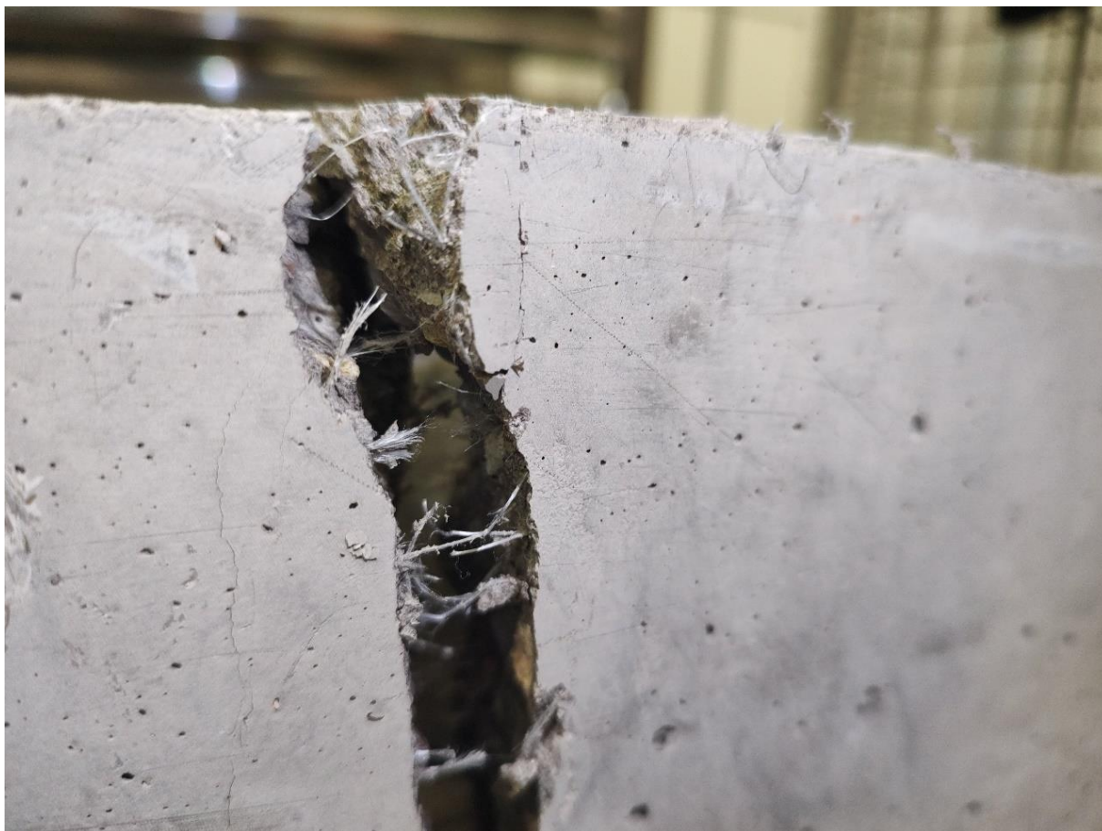
Obrázek 38 Přetrhaná vlákna na spodním líci zkušebního trámce (Mapefibre ST 50 Twisted)
