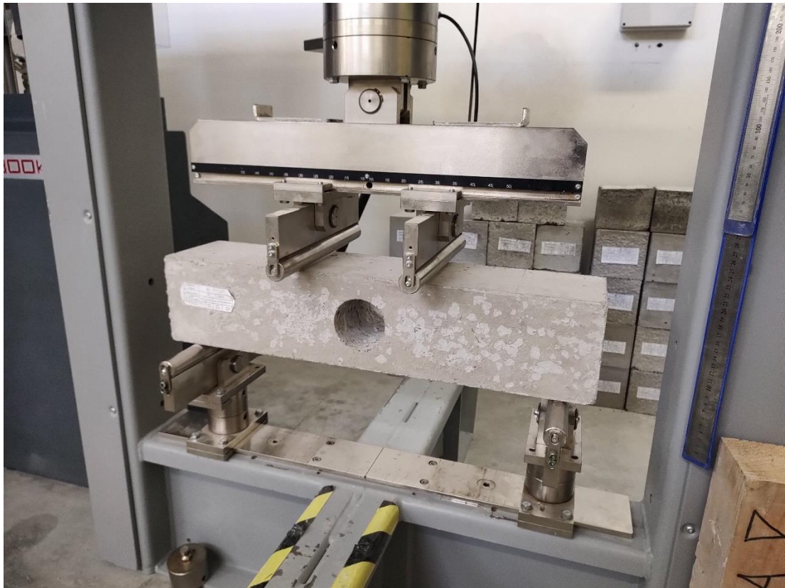
Obrázek 36 Zkušební těleso umístěno v lisu před započítím zkoušky
