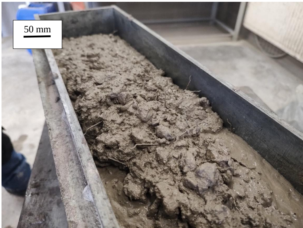
Obrázek 18 Plnění formy, všesměrně rozptýlená vlákna Krampe Harex
