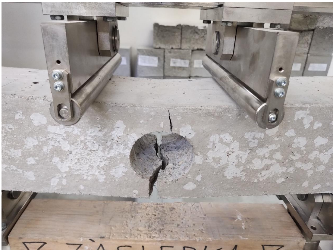
Obrázek 37 Zkušební trámec po ukončení zkoušky (Masterfibre 482)
