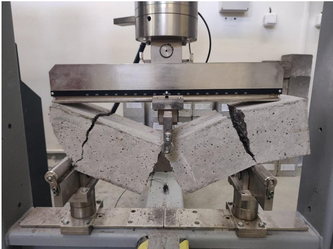
Obrázek 34 Poškozený trámec při nestandardním průběhu zkoušky
