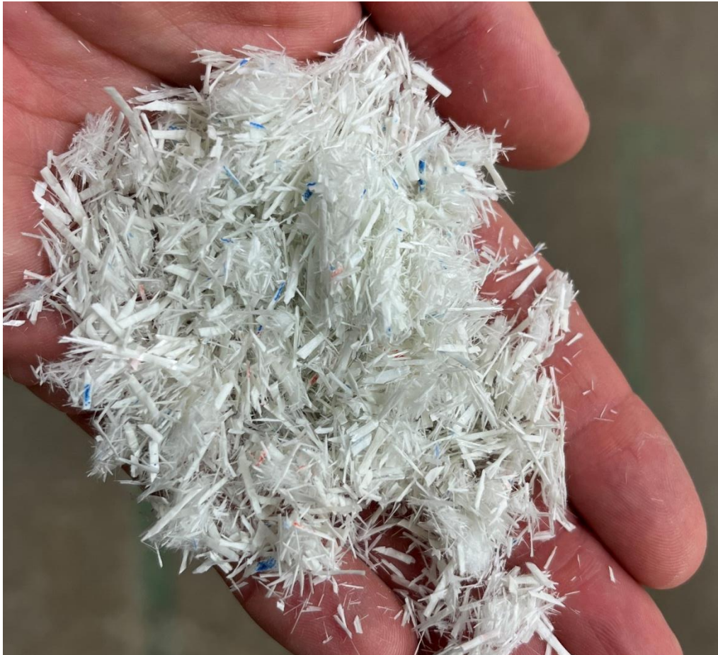
Obrázek 28 Skelný prototyp vláken, foto Ing. Šmíd, CEMEX
