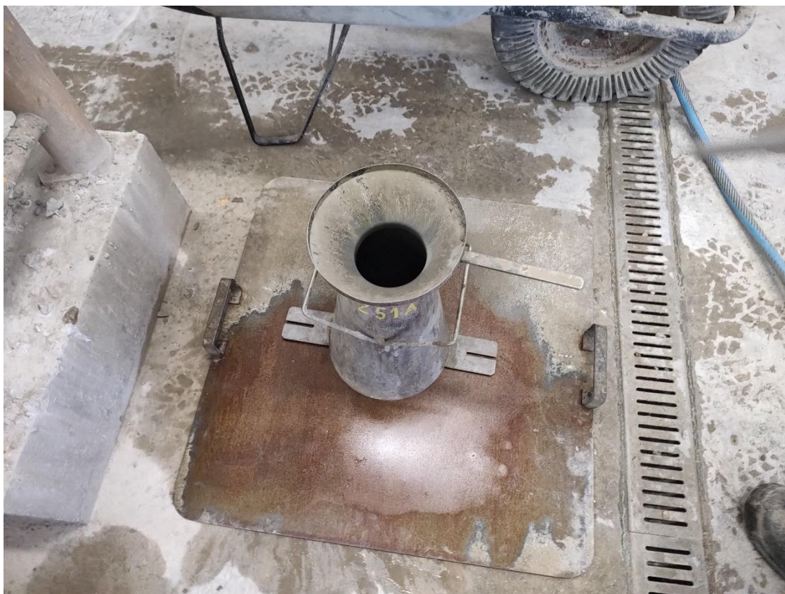
Obrázek 14 navlhčený Abramsův kužel před zkouškou sednutím na navlhčené podložce
