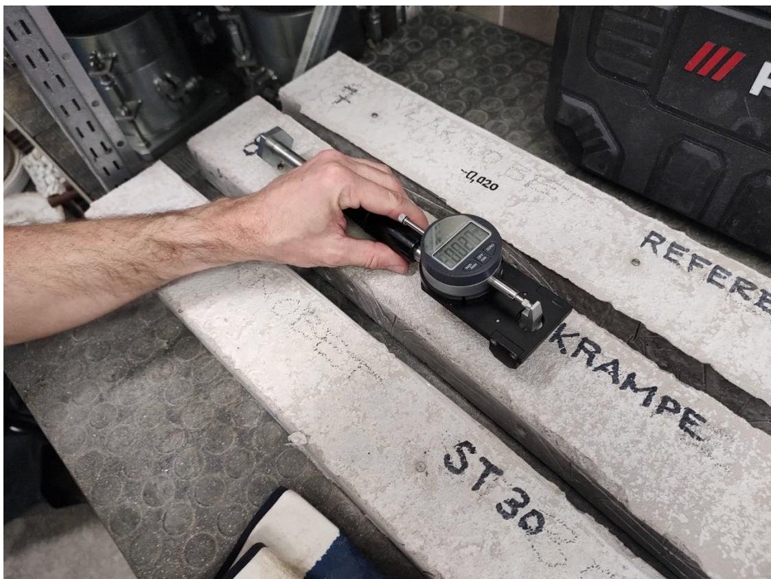
Obrázek 49 Manuální měření objemových změn
