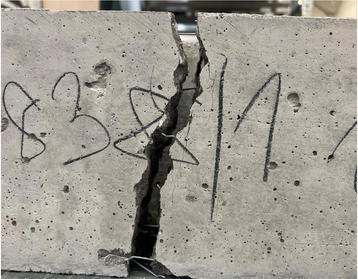
Obrázek 40 Makrotrhlina s prosvítajícími vlákny po zkoušce osový tah, vlákna Krampe Harex, receptura 2, foto Ing. Šmíd, CEMEX
