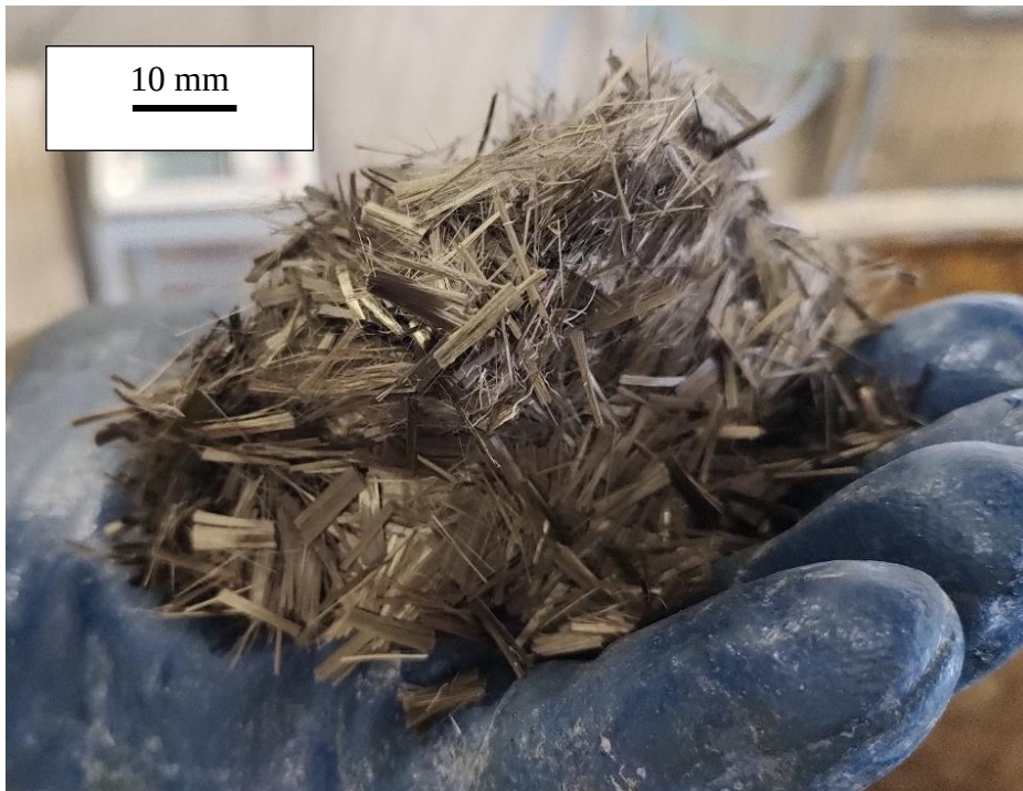
Obrázek 26 Čedičové mikrovláknó Orlimex
