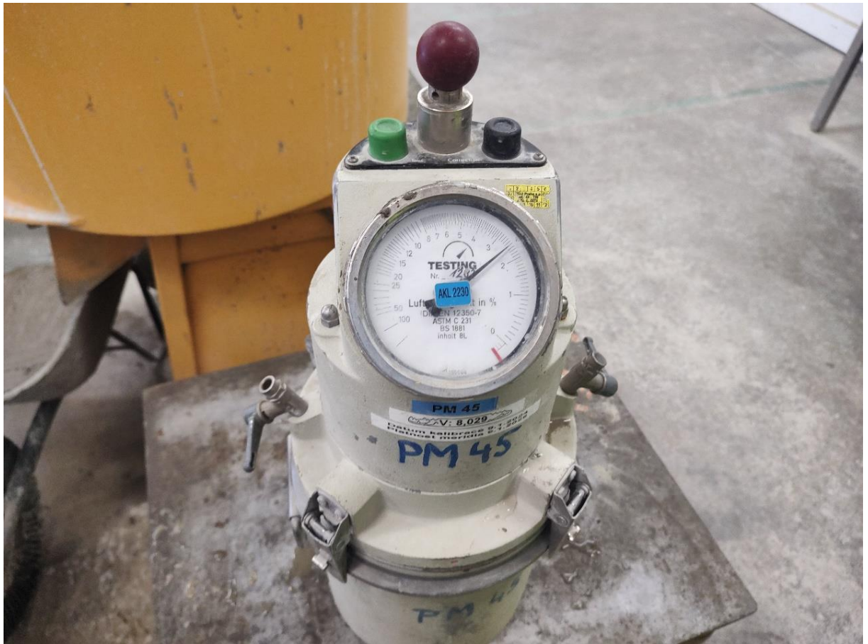
Obrázek 16 Stanovení obsahu vzduchu v ČB
