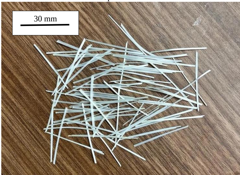
Obrázek 27 Skelné vlákno Anti crack 67/36 [31]
