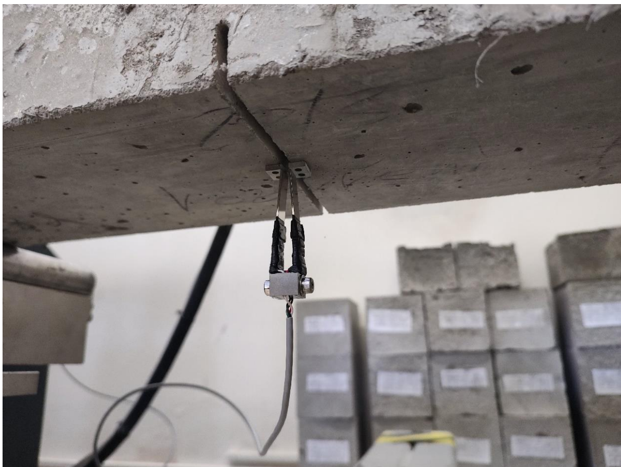
Obrázek 31 Čidlo pro zaznamenávání velikosti rozevření trhliny
