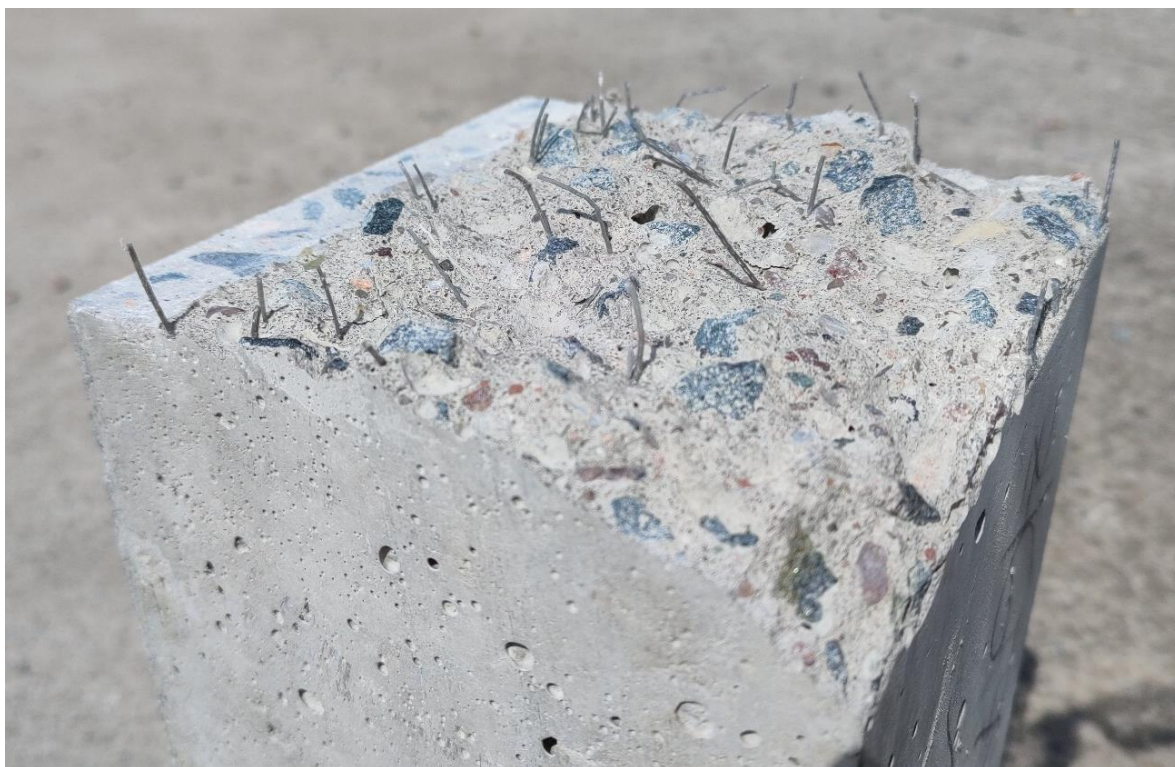
Obrázek 33 Porušený průřez po zkoušce Rozevření trhliny, směs 3, vlákna Mapefibre ST 30
