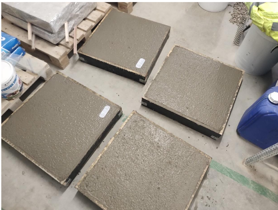
Obrázek 41 Zkušební těleso pro zkoušku Stanovení absorbované energie, ihned po naplnění formy
