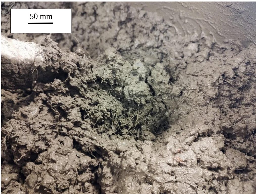
Obrázek 25 Mapefibre ST 50 Twisted rozptýleno v čerstvém betonu
