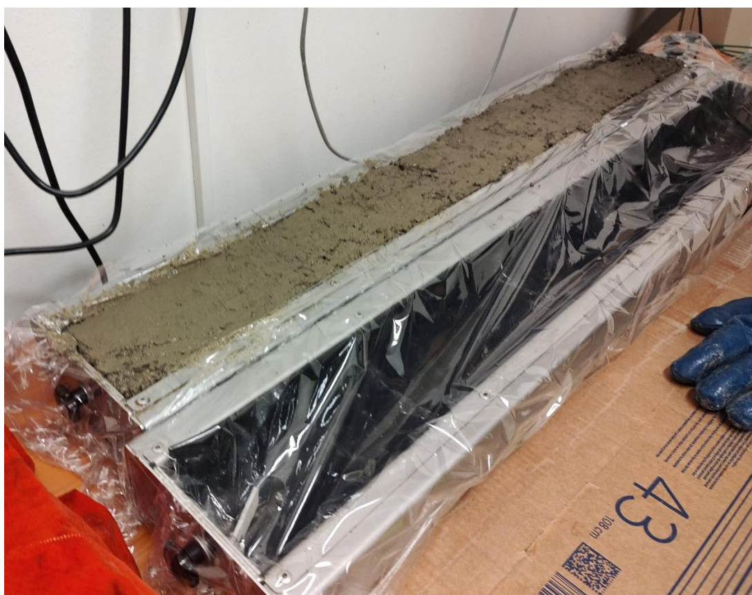
Obrázek 46 Měřicí žlab po naplnění čerstvým betonem
