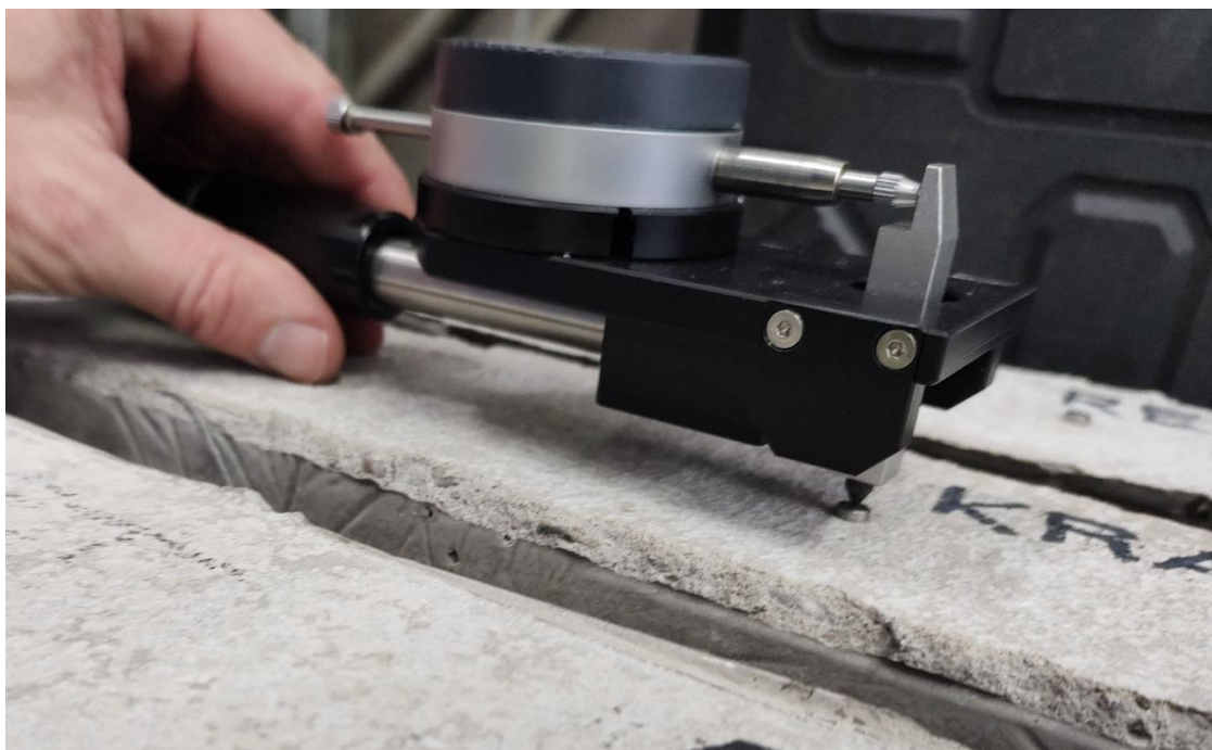
Obrázek 50 Přiložený odchylkoměr na měřicím bodě
