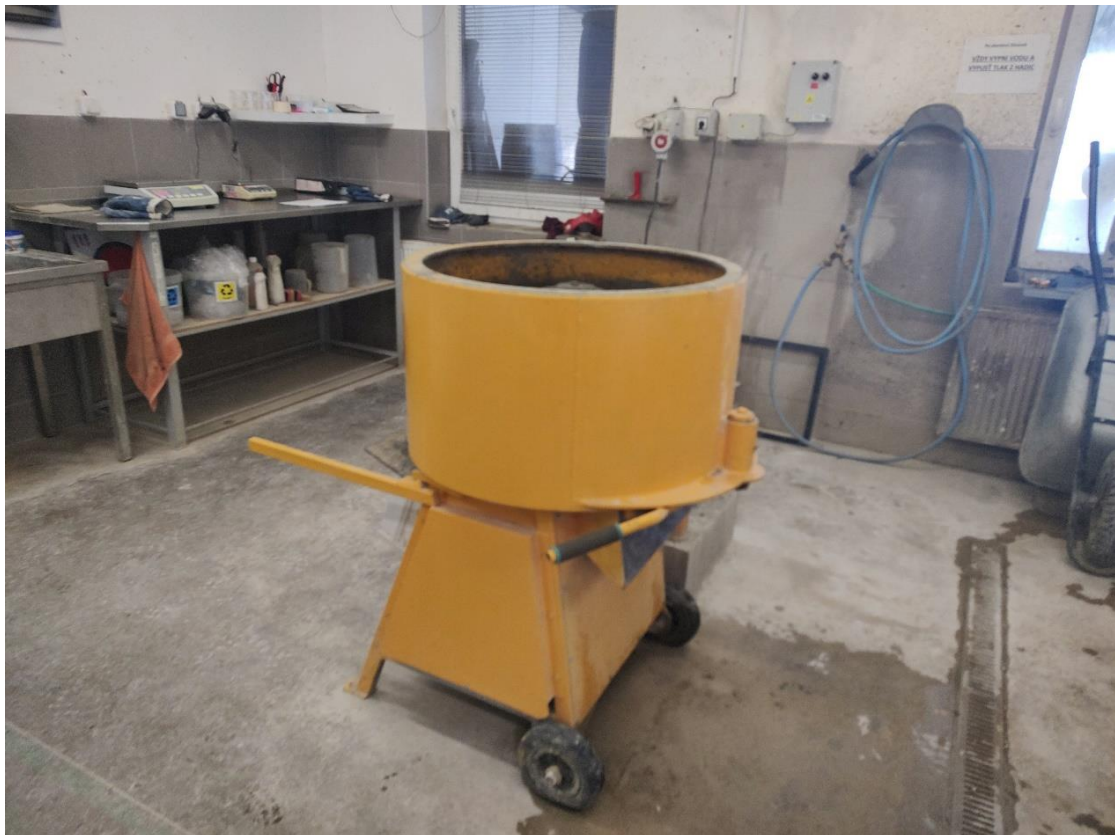
Obrázek 13 Vertikální míchačka s nuceným oběhem
