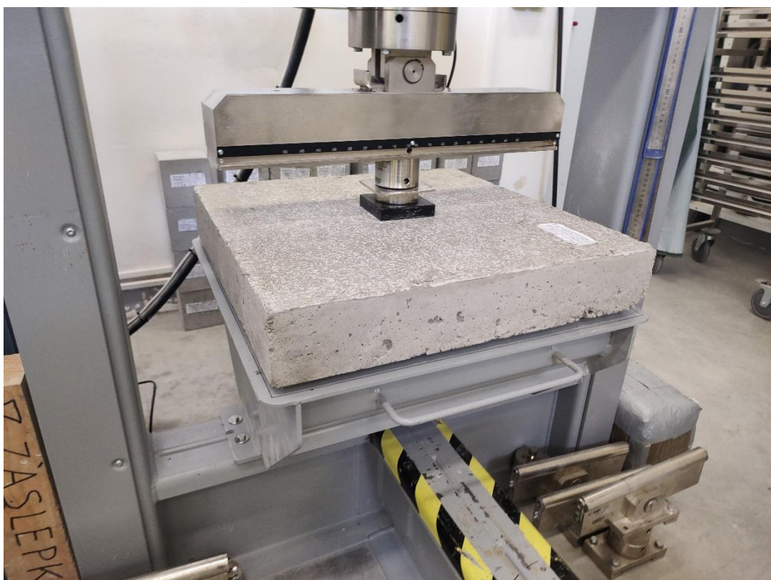
Obrázek 43 Zkušební těleso umístěno v lisu před začátkem zkoušky
