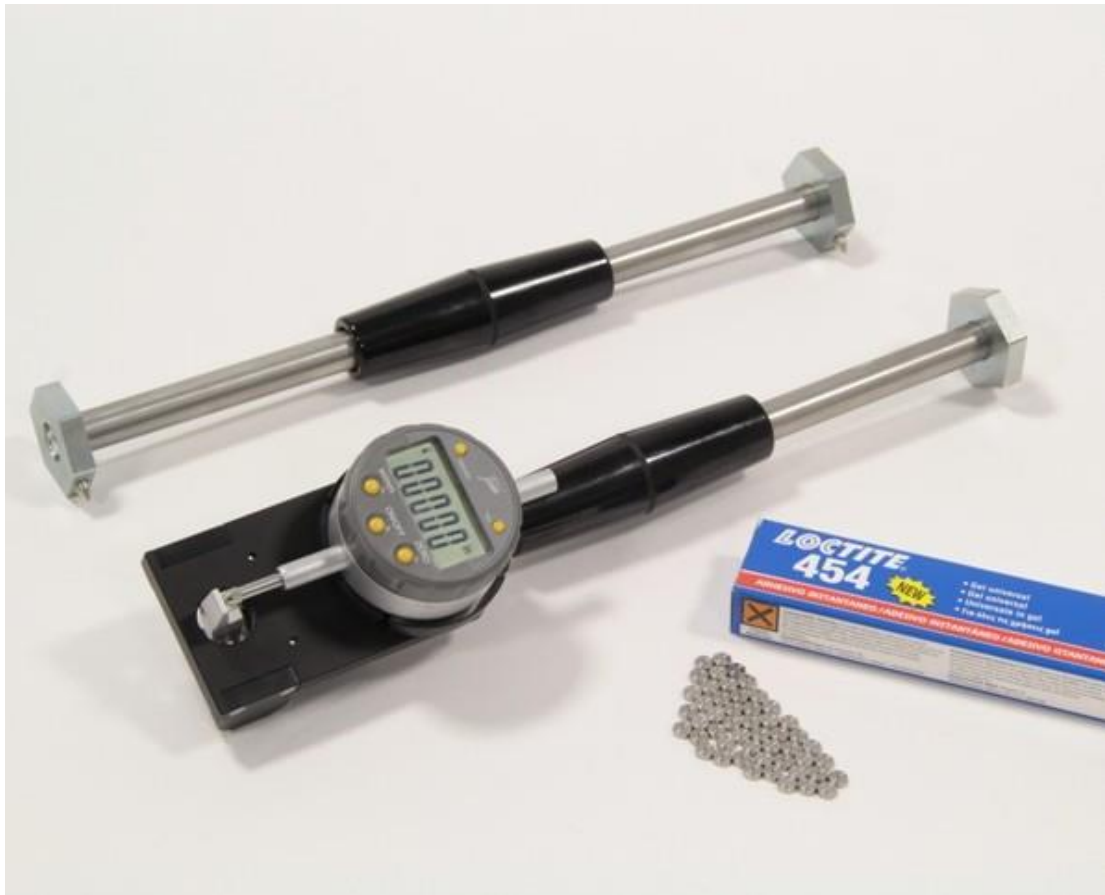
Obrázek 48 Nástroj pro manuální měření deformací [23]
