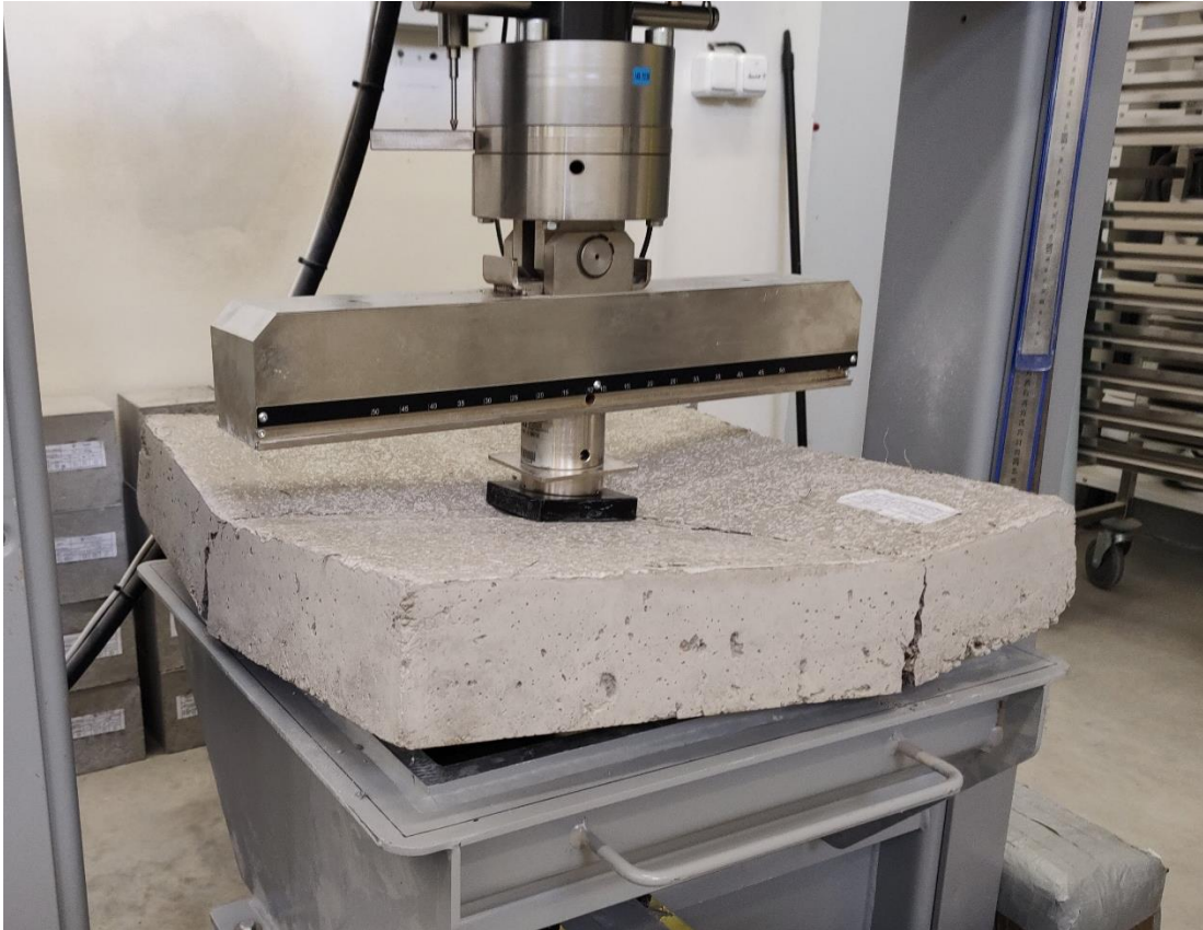
Obrázek 44 Deformace tělesa po ukončení zkoušky
