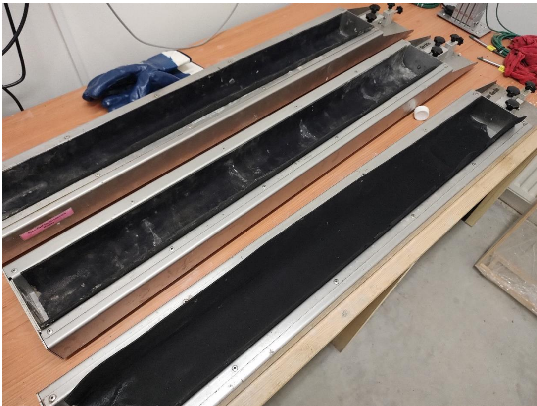
Obrázek 45 Měřicí žlab SCHLEIBINGER GERÄTE – připraven na naplnění čerstvým betonem
