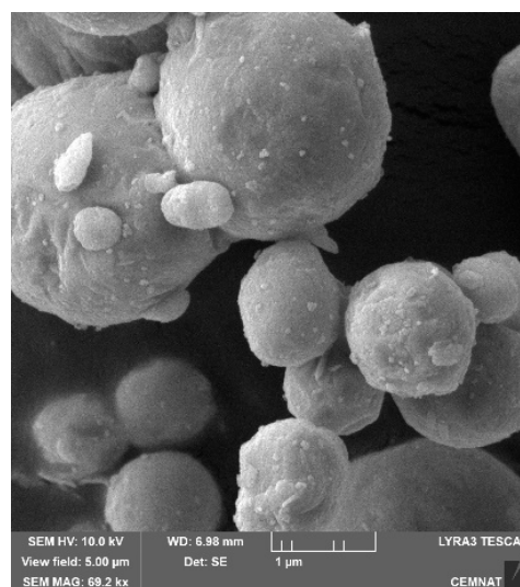
Obrázek 3: Mikrofotografie práškového zinku pořízené skenovacím elektronovým mikroskopem
